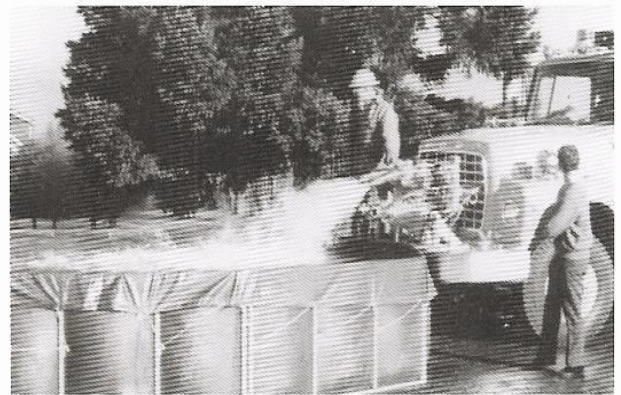
Figura 11.37 Los conformadores de corriente se utilizan para garantizar que toda el agua va en dirección al tanque portátil. Se utilizan principalmente cuando se bombea agua fuera del vehículo.
