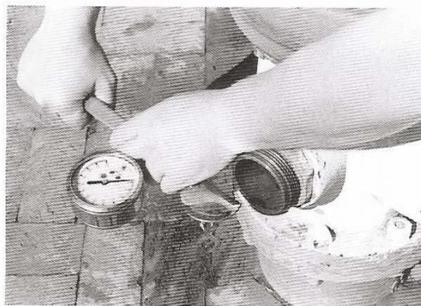
Figura 11.25 Establece el tubo de Pitot apoyando la parte izquierda del puño contra el orificio de descarga. A continuación, deslice la hoja en el chorro.
