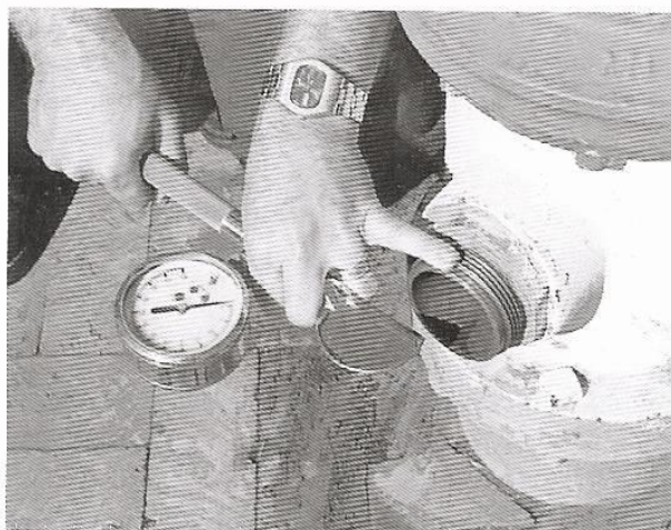
Figura 11.24 Utilice el dedo meñique para mantener estable el tubo de Pitot.
