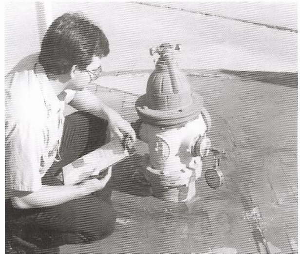
Figura 11.18 La presión residual de un hidrante se mide mientras se descarga el agua de otro hidrante.
