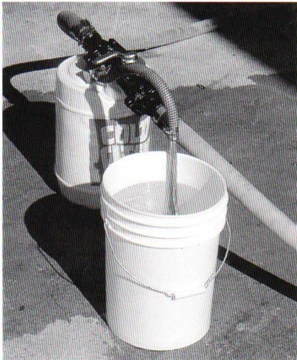
Figura 13.48 El tubo eductor de espuma se limpia insertando el tubo colector en un contenedor de agua limpia durante algunos minutos.
