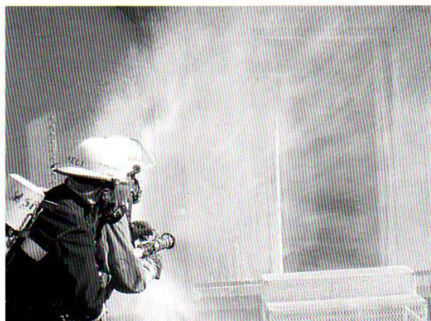
Figura 13.26 La espuma de clase A puede descargarse a través de una boquilla nebulizadora normal. Gentileza del Distrito de protección contraincendios de Mount Shasta, California.
