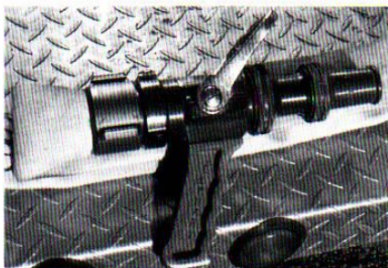
Figura 13.42a Boquilla de cilindro directo utilizada para chorros con sistemas de espuma de aire comprimido. Gentileza del Distrito de protección contraincendios de Mount Shasta, California.
