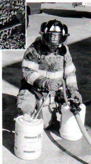
Figura 13.38 El tubo colector se sumerge en el contenedor de espuma.
