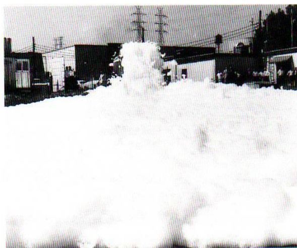
Figura 13.47 Los sopladores mecánicos generan cantidades masivas de espuma de expansión alta. Gentileza de Walter Kidde, Inc.
