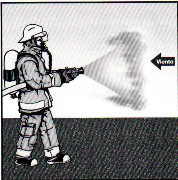
Figura 13.16 El viento y las corrientes de aire afectan fácilmente a las partículas de agua finas.
