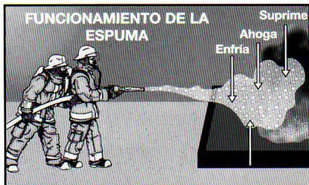
Figura 13.24 La espuma enfría los vapores, los ahoga, los separa y, finalmente, los suprime.
