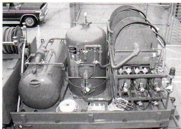
Figura 13.35c Las unidades de agente doble pueden montarse sobre carros de mano o en la parte trasera de un vehículo. Gentileza de Conoco Oil Co.
