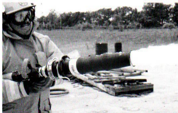
Figura 13.44 Algunos fabricantes de boquillas nebulizadoras disponen de accesorios de aireación para sus boquillas que pueden utilizarse durante las actuaciones con espuma. Gentileza de KK Productions.
