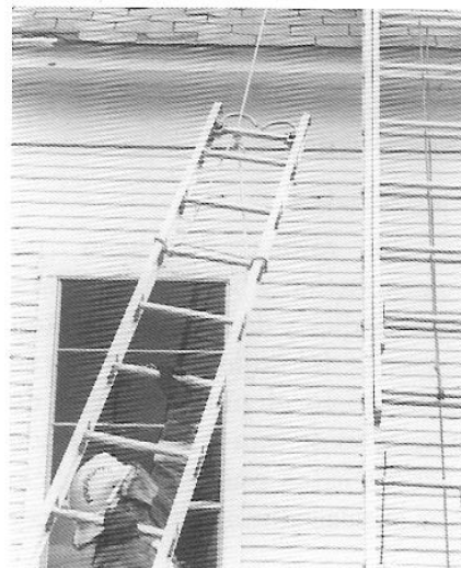
Figura 6.23 Para izar una escala, utilice un as de guía o un nudo de ocho de una vuelta y páselo primero a través de dos peldaños a una distancia de un tercio de la parte superior. Después de tirar de la gaza a través, deslícela por encima de la escala.
