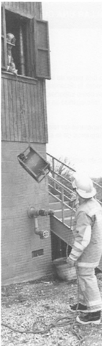
Figura 6.24 Utilice un nudo de ocho de unión o un as de guía para izar un extractor portátil. Observe que el cable de cola evita que el extractor choque contra el edificio.
