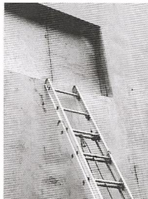
Figura 9.53 Para efectuar un rescate, coloque el cabezal justo por debajo del alféizar inferior.
