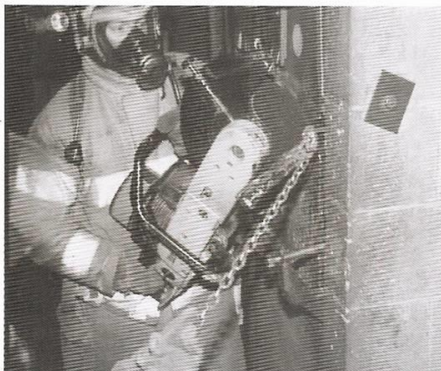
Figura 8.68 Cuando se corta el brazo de un candado con una sierra circular, una segunda persona debe sujetar el candado con la mordaza de presión y la cadena.
