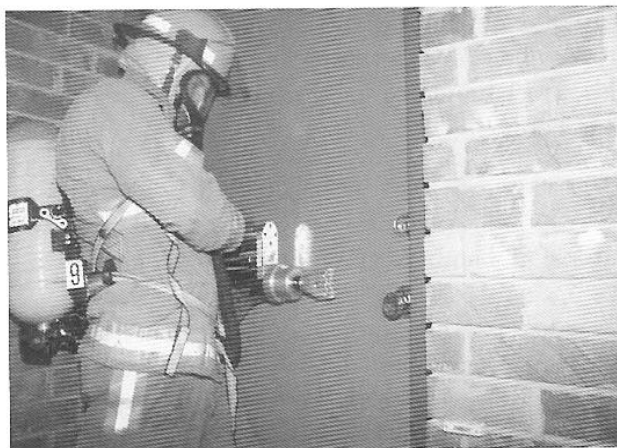
Figura 8.11 Se puede utilizar un ariete hidráulico para que oscile una puerta abierta.
