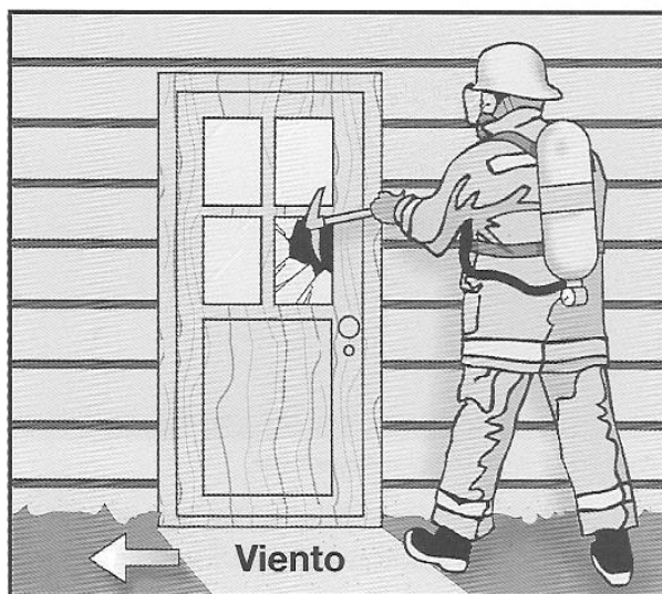
Figura 8.52 Permanezca en el lado de barlovento mientras rompa un cristal.
