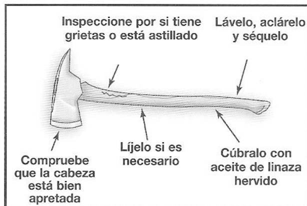
Figura 8.20 Se deben inspeccionar estas áreas de los mangos de madera.
