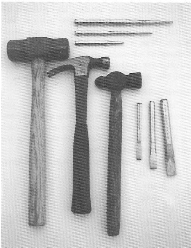
Figura 8.15b En el kit de herramientas para entrada forzada deben incluirse varios martillos, mazas, punzones y cinceles.
