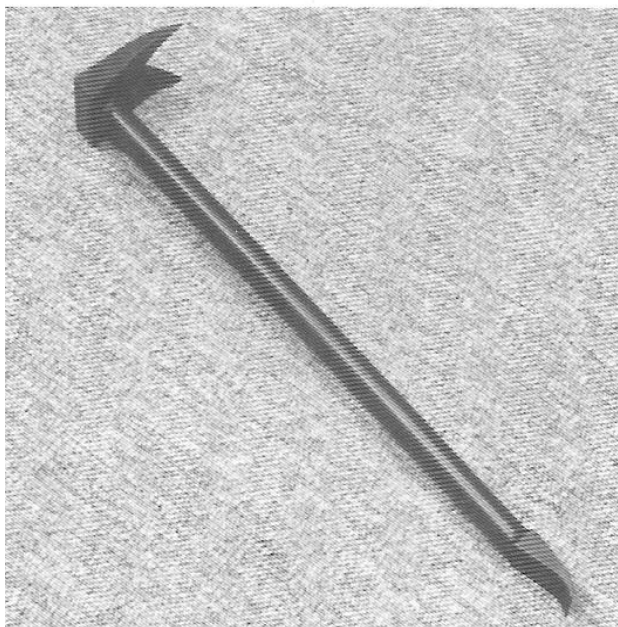
Figura 8.61 La herramienta de pata de cabra está diseñada para arrancar los cilindros de la cerradura.
