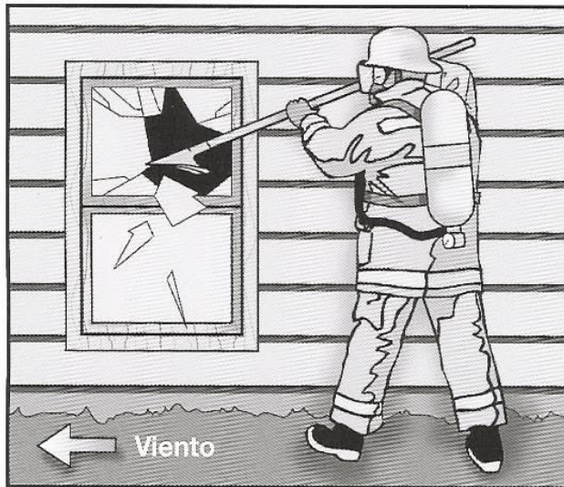
Figura 8.73 Las manos del bombero deben estar por encima del punto de impacto para evitar que los fragmentos de cristal caigan encima de él.
