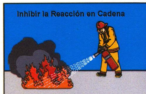
También podemos **eliminar la reacción química en cadena**. Se aplica en combustibles gaseosos o líquidos. Utiliza químicos secos e hidrocarburos halogenados. Interrumpe la reacción química en cadena (pone fin a las llamas).
