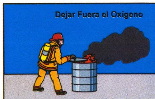
Para eliminar el oxígeno se utiliza la **sofocación**. Se aplica en combustibles sólidos, líquidos, o gaseosos. Evita que el aire entre en contacto con el combustible (sofocamiento). Se puede diluir o desplazar el oxígeno con un gas inerte como el  $\text{CO}_2$  o el Halocarbono.
