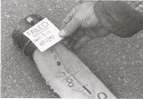
**Paso 28.** Observe las marcas hechas en la manguera a la altura de las conexiones.
