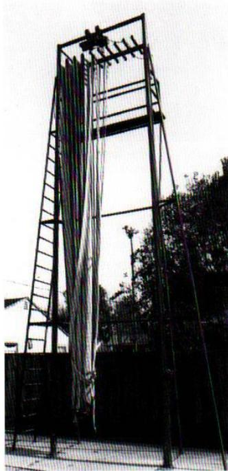
**Figura 12.7** Las torres para mangueras están diseñadas para colgar las mangueras y secarlas de forma adecuada.
