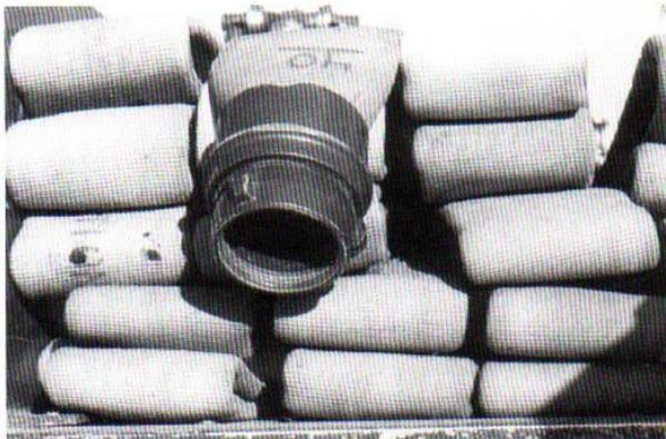
Figura 12.74 En un tendido hacia el incendio, la conexión hembra sale primera.
