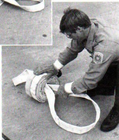
**Paso 5.** Empiece a enrollar hacia las conexiones, formando dos rollos paralelos.
