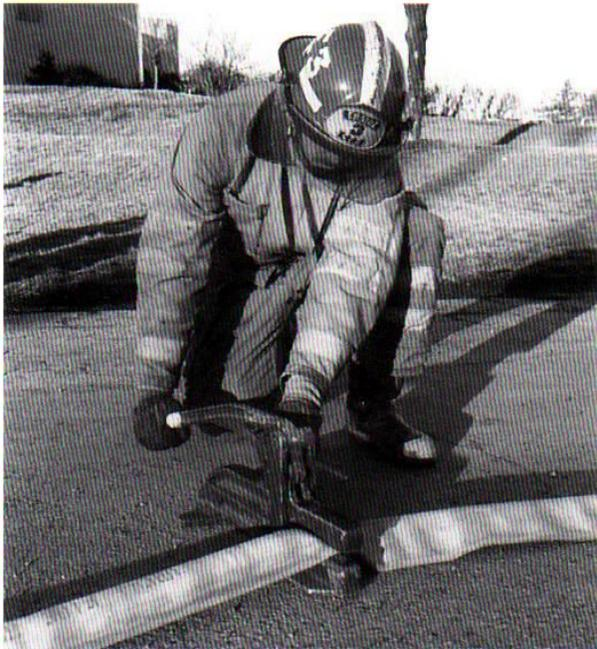
Figura 12.44 Quédense siempre de pie y a un lado cuando apriete o afloje una abrazadera a presión.
