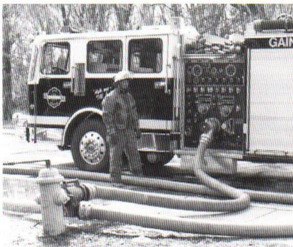
**Paso 8.** Conecte una línea de descarga a la toma de la válvula de cuatro vías.
