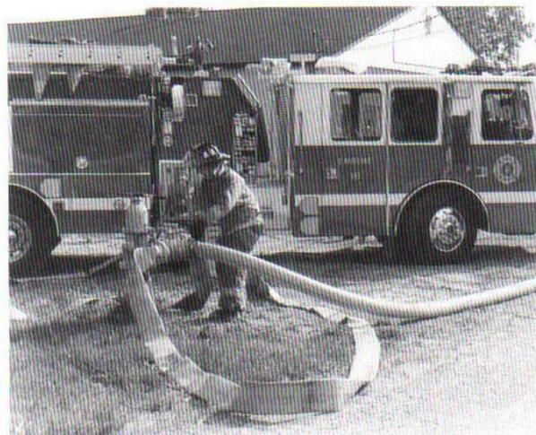
**Figura 12.75** Bombero que conecta una válvula de cuatro vías para hidrante al autobomba. *Gentileza de Harrington, Inc.*
