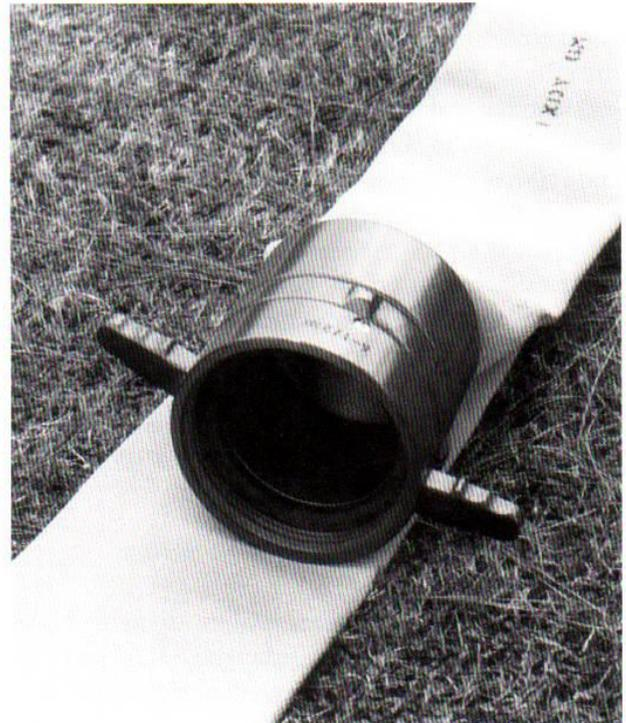
**Figura 12.18** Conexión de una manguera de toma.
