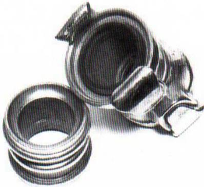
**Figura 12.16** Las conexiones de broches se cierran la una a la otra cuando los dos cierres con muelle de la conexión hembra se enganchan a la arandela de la taza de la conexión macho.
