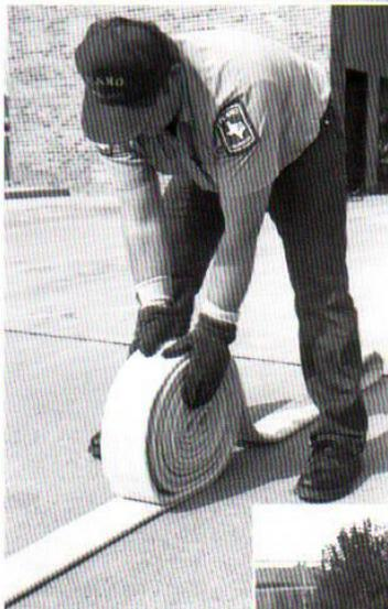
**Paso 3.** Enrolle la manguera hacia el extremo hembra. Deje espacio suficiente en la gaza central para poder meter la mano y acarrear la manguera.
