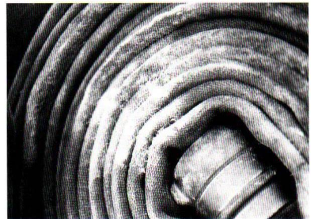
**Figura 12.9** El moho puede debilitar el revestimiento de una manguera con recubrimiento textil. *Gentileza de Keith Flood.*
