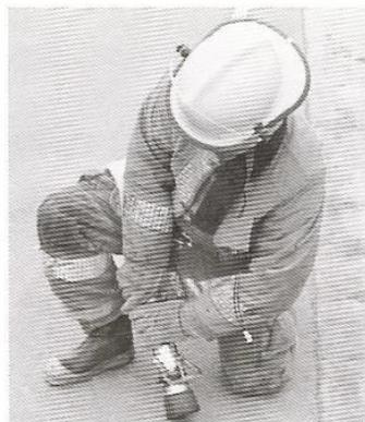
**Paso 9.** Conecte una boquilla cerrada (u otro dispositivo que permita drenar agua y aire de la manguera) al extremo abierto de cada tramo de pruebas.
