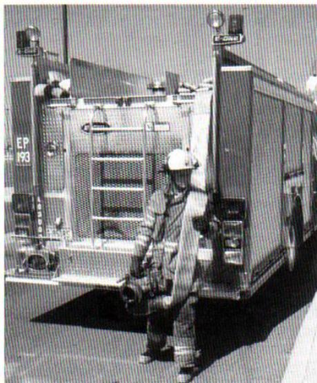
**INSTRUCCIONES:** el conductor/operario detiene el vehículo contra incendios aproximadamente a 3 m (10 pies) del hidrante. La persona que está junto al hidrante realiza los pasos del 1 al 8.
