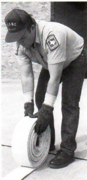
**Paso 3.** Siga enrollando la conexión en la manguera formando un rollo igualado.
