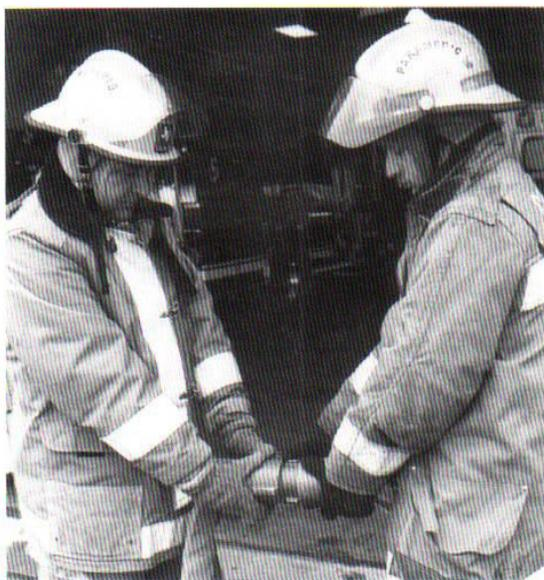
**Paso 1. Ambos bomberos.** Tomen con firmeza y con ambas manos la conexión respectiva de cada uno de ustedes y presiónenla hacia el otro bombero comprimiendo la junta de la conexión.
