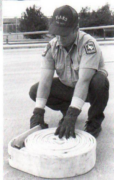
**Paso 4.** Extienda el trozo de manguera del extremo hembra sobre el roscado de la conexión macho para protegerlo.
