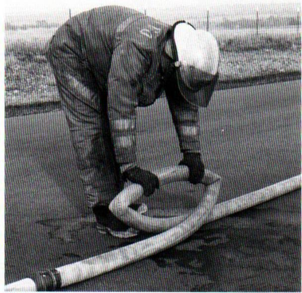
**Figura 12.91** Se puede doblar la manguera para detener el flujo de agua.
