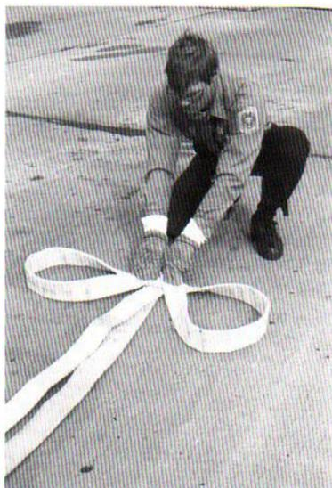
**Paso 4.** Ponga las conexiones de los extremos uno enfrente del otro. Mueva la parte de atrás de la gaza hacia las conexiones y colóquela en el punto en que se cruza la manguera.
