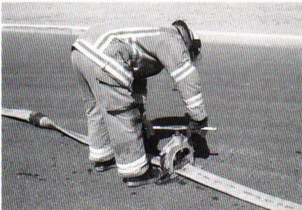
**Paso 5. Bombero.** Aplique una abrazadera para mangueras a la manguera en el vehículo de ataque.
