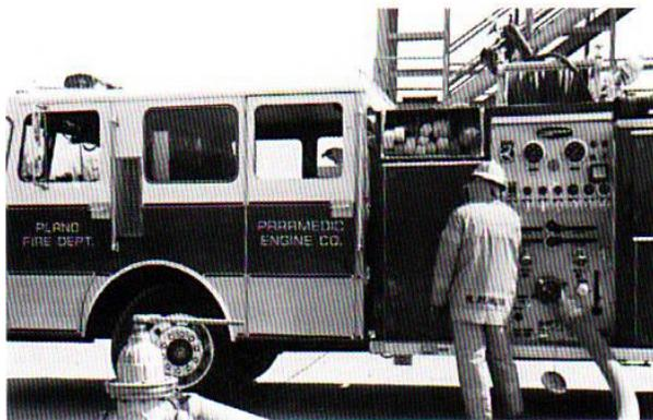
Figura 12.2 Una manguera blanda transporta agua desde el hidrante a la toma de la bomba.
