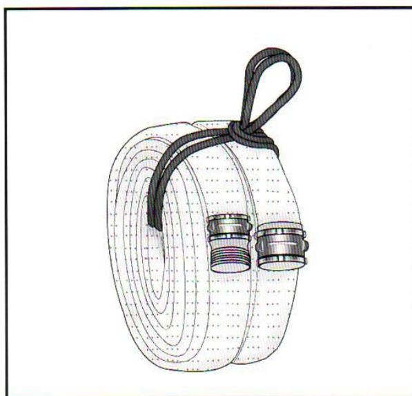
Figura 12.51 Enrollado con dos conexiones paralelas.
