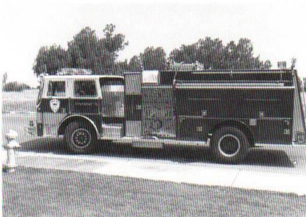
**Paso 1. Conductor/operario.** Sitúe el vehículo con una inclinación adecuada respecto al hidrante y dentro de los límites de la longitud de la manguera de toma.
