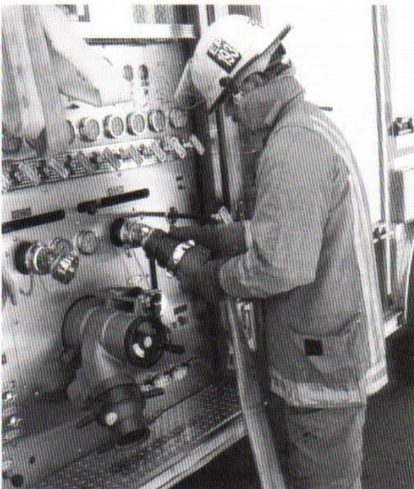
**Paso 10.** Conecte la manguera de abastecimiento a una válvula de descarga.
