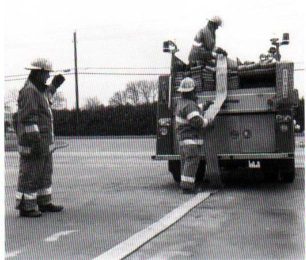
Figura 12.61 Se puede acomodar una manguera de gran diámetro montándola directamente en el vehículo y conduciendo lentamente hacia atrás a medida que se acomoda la manguera en la cama.
