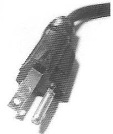
**Figura 1.40** Si una herramienta no tiene un doble aislamiento, debe utilizarse un enchufe de tres clavijas.
