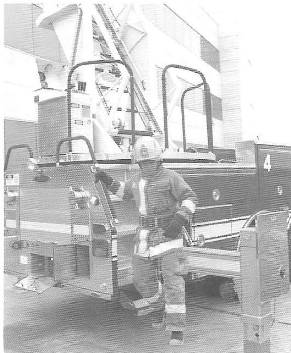
Figura 1.34 Salte de los vehículos elevados que puedan estar en contacto con cables con carga eléctrica.
