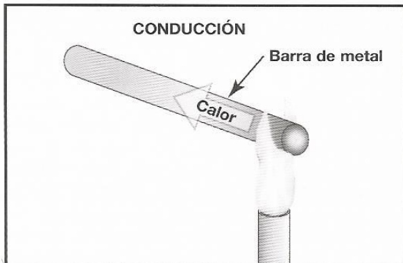
Figura 2.4 La temperatura a lo largo de la barra sube por causa del mayor movimiento de moléculas debido al calor de la llama. Éste es un ejemplo de conducción.
