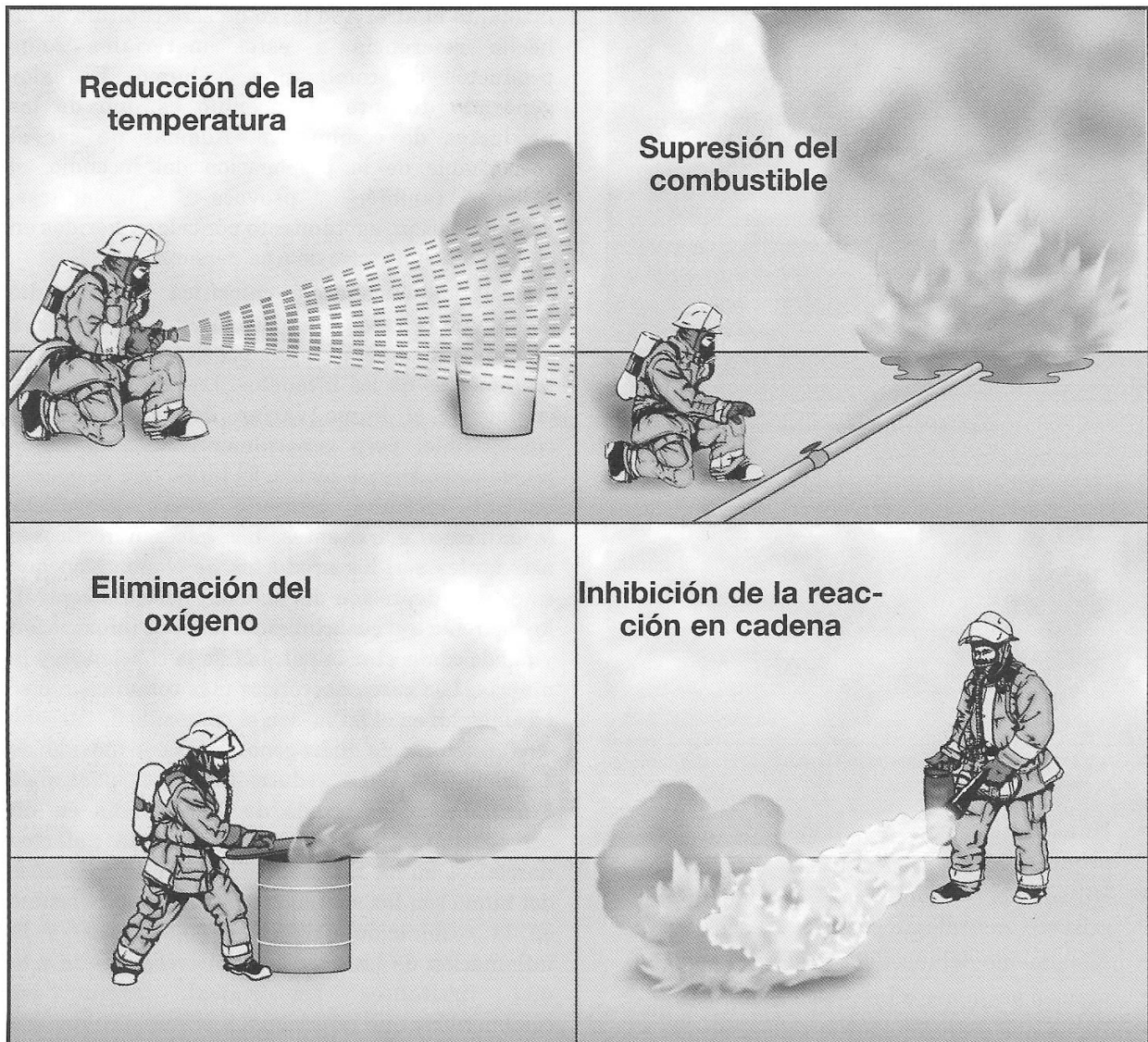
Figura 2.28 Cuatro métodos de extinción de incendios.
