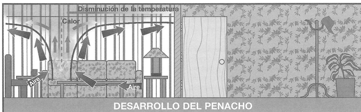
Figura 2.18 Al principio, la temperatura de los gases del fuego disminuye a medida que éstos se desplazan lejos de la línea central del penacho.
