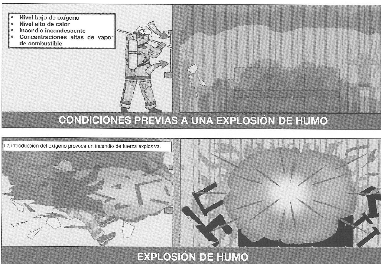
Figura 2.26 La ventilación inadecuada durante una actuación contra un incendio puede provocar una explosión de humo.
