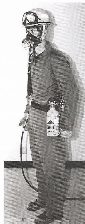
Figura 4.54 El equipo de respiración de línea de aire es útil para las actuaciones de larga duración.
