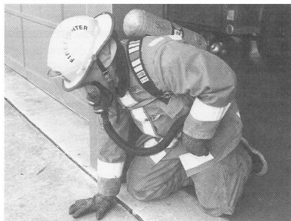
Figura 4.78 Bombero utilizando la válvula de paso directo por un mal funcionamiento o daño en el regulador.
