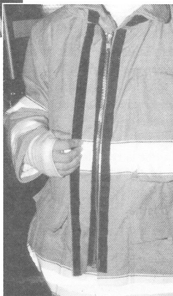
Figura 4.15 El protector de tormenta cubre el área de cierre y evita que el vapor, el agua y los productos del fuego entren por los agujeros entre los cierres.
