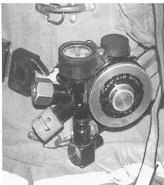
Figura 4.38 El regulador controla el flujo de aire para satisfacer los requisitos respiratorios del usuario.
