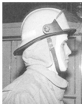
Figura 4.4 Todos los cascos deben tener protectores para las orejas y tiras para la barbilla.
