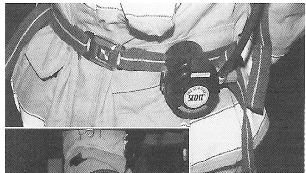
Figura 4.36 El cinturón ayuda a distribuir el peso del cilindro.
