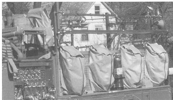
Figura 4.66 Las fundas de lona ayudan a proteger los aparatos de respiración de un exceso de suciedad y humedad. Gentileza de Ron Bogardus.
