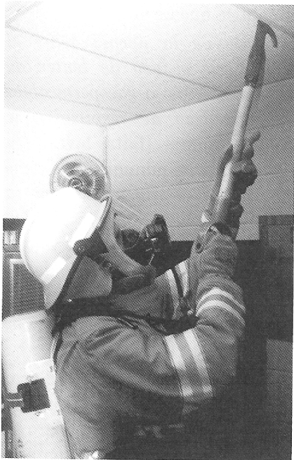
Figura 4.34 El aparato de respiración reduce la movilidad del bombero; por ejemplo, trabajar por encima de la altura de la cabeza puede ser difícil.
