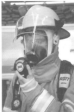
Figura 4.39 Este regulador se conecta directamente a la máscara.
