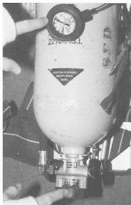
Figura 4.43 La lectura del manómetro de presión del cilindro y la lectura del manómetro remoto deben compararse.
