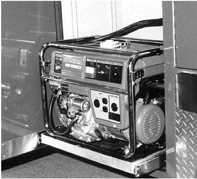
Figure 2.23 Muchos vehículos transportan generadores eléctricos portátiles en un compartimento.
