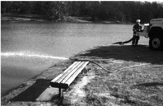
Figura 11.54 Vuelva a descargar un chorro en la fuente de agua siempre que pueda para evitar una pérdida de cebado.
