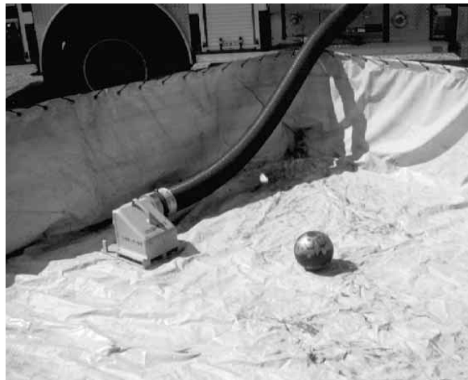
Figura 14.43 La manguera de toma y el filtro para niveles de agua bajos se colocan en el depósito portátil.
