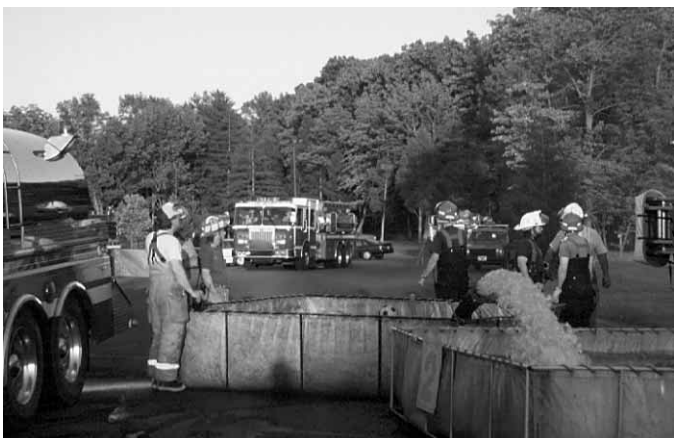
Figura 14.23 Si se ubica el lugar de vaciado en una intersección, pueden reducirse al mínimo las maniobras que hay que realizar con el vehículo.
