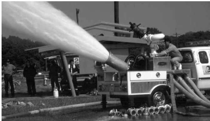
Figura 15.38 Dispositivo de chorro maestro de espuma. La boquilla montada en el vehículo es capaz de descargar 32.000 L/min (8.000 gpm) y se abastece de hasta 6 mangueras de 125 mm (5 pulgadas).
