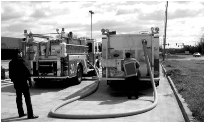
Figura 14.2 El autobomba del lugar de llenado carga camiones cisterna vacíos que proceden del lugar de vaciado.
