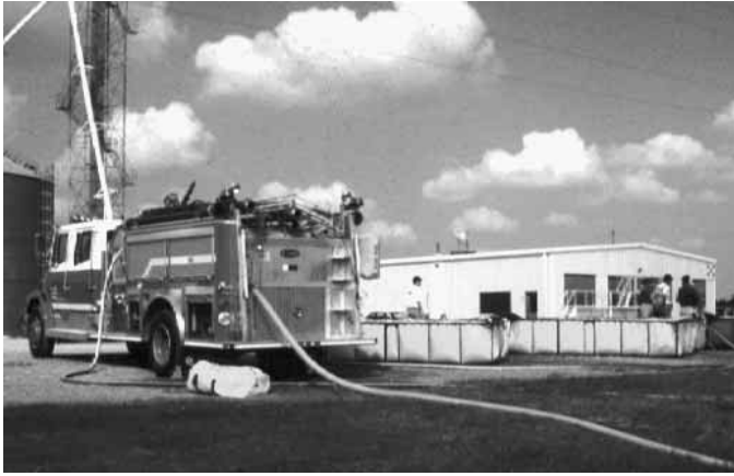
Figura 14.51 Las actuaciones de trasvase de agua de gran volumen necesitan que los lugares de vaciado dispongan de múltiples depósitos portátiles.
