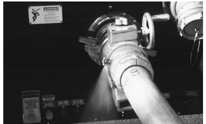
Figura 13.7 Utilice la válvula de desahogo para descargar el aire de la manguera a medida que se llena de agua.
