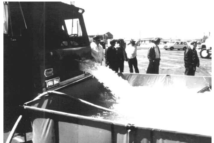
Figura 14.16 Algunos camiones cisterna especializados disponen de orificios de vaciado frontales.
