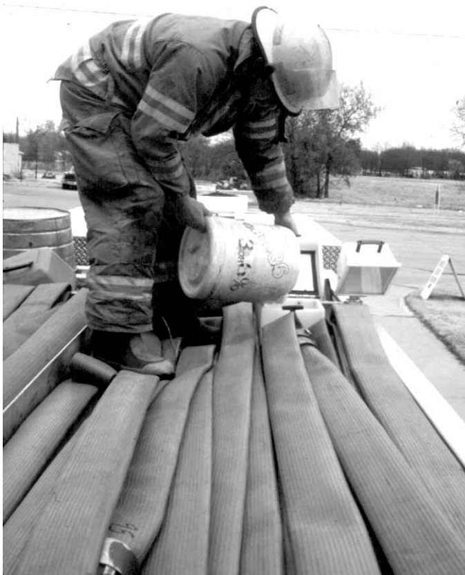
Figura 2.4 La mayoría de autobombas municipales equipados con depósitos de espuma se rellenan con bidones de 20 L (5 galones).
