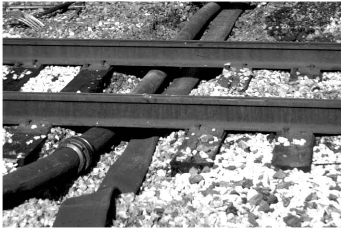
Figura 5.77 En algunos casos, la manguera se puede pasar por debajo de las vías de modo que no se interrumpa ni el tráfico de trenes ni las actuaciones contraincendios.
