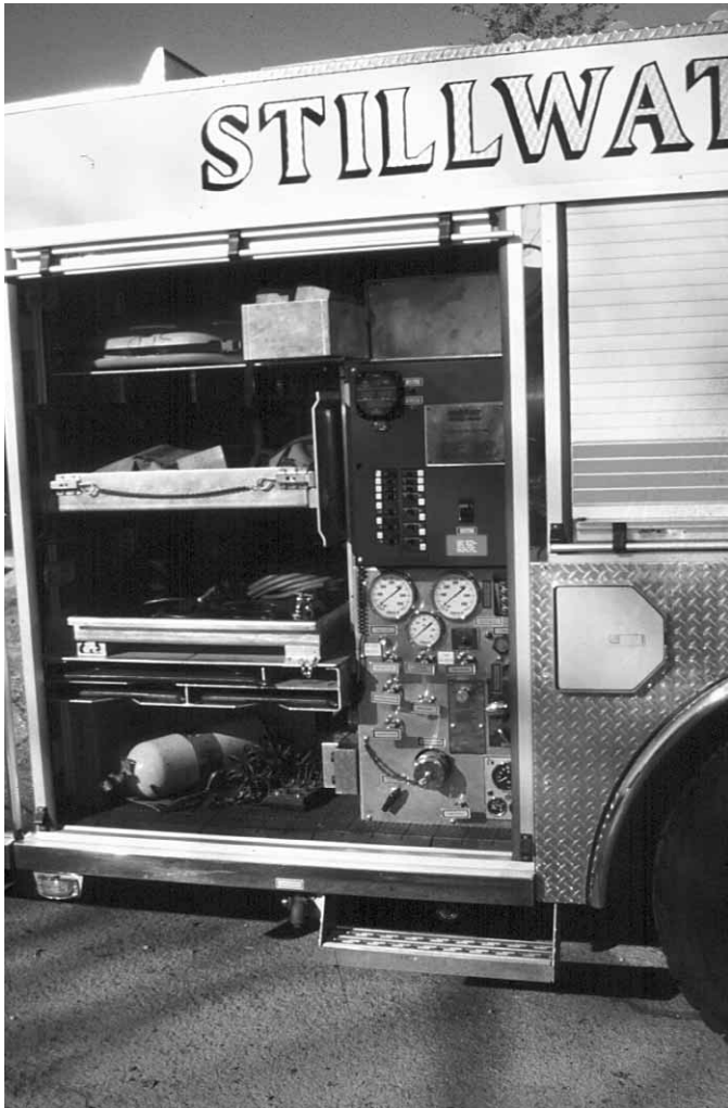
Figura 2.21 Algunos vehículos de rescate están equipados con bombas de ataque y cisternas de agua pequeñas, por lo que ofrecen una protección contraincendios inferior a la de los autobombas de rescate.
