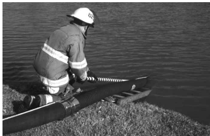
Figura 11.55 Puede utilizar una pértiga con gancho para retirar los escombros del filtro.
