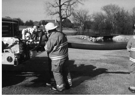
Figura 5.23b Conecte la manguera de toma a la bomba contraincendios mientras se encuentre en una superficie segura.
