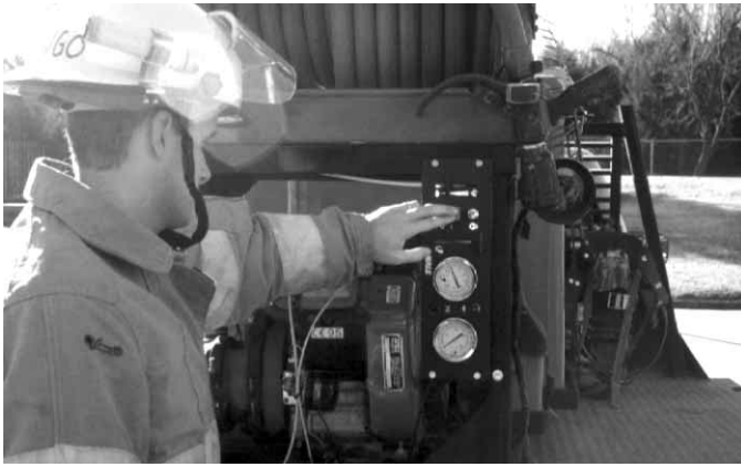
Figura 11.11 Para activar la bomba, el conductor/operario tan sólo tiene que apretar el botón de encendido del motor .
