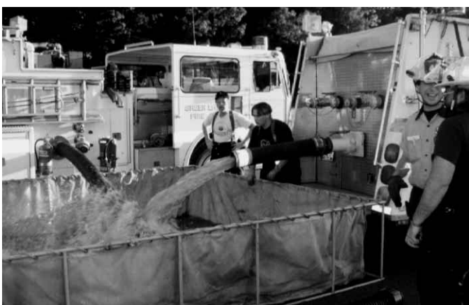
Figura 14.46 Las actuaciones con un solo depósito portátil son adecuadas para las actuaciones que requieren un abastecimiento de agua pequeño.
