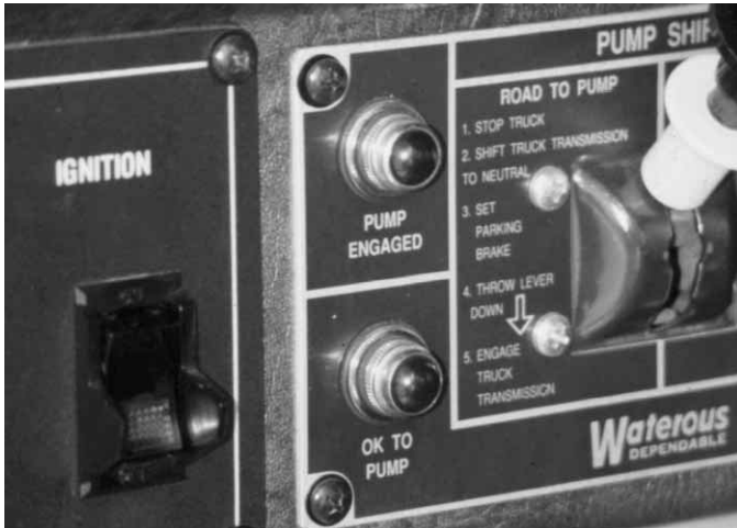
Figura 11.10 Este indicador luminoso se enciende cuando se realiza un cambio adecuado en la bomba.
