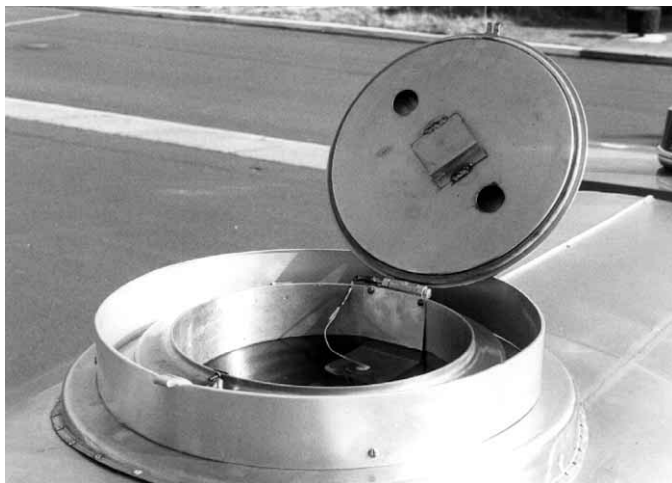
Figura 14.19 Ventilación típica de depósito. Gentileza de Bob Esposito.
