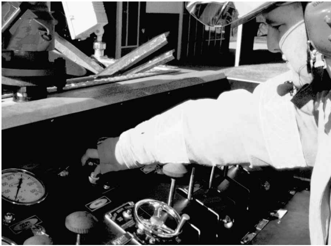
Figura 11.13 Aumente la aceleración para proporcionar la presión de descarga suficiente.
