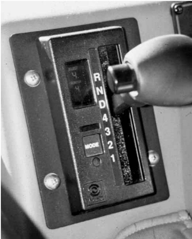
Figura 10.35 La transmisión automática se bloquea cuando la bomba está en marcha.
