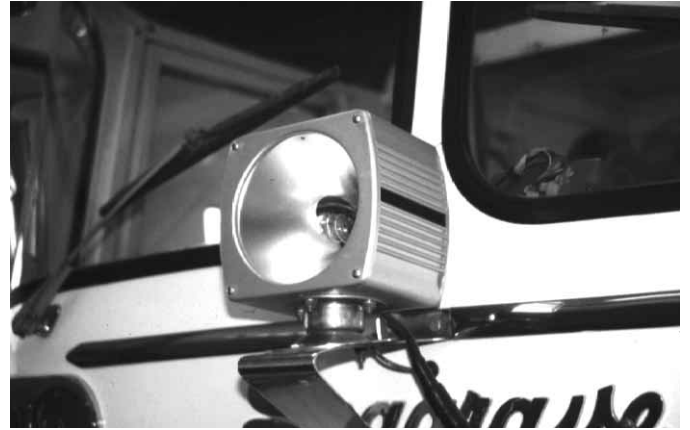
Figura 4.49 El emisor Opticom™ se coloca en el vehículo. Puede colocarse en una barra junto con otras luces o puede estar separado.
