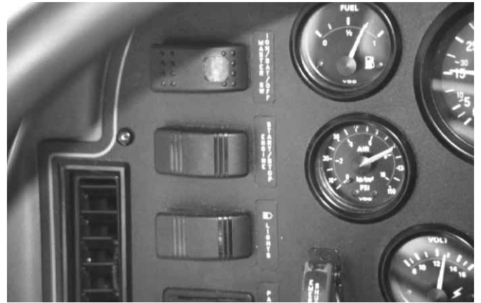
Figura 4.15a Algunos interruptores de los contactos son conmutadores de palanca.
