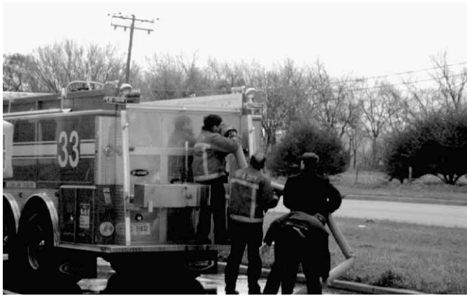
Figura 14.14 Las mangueras de gran diámetro pueden ser difíciles de manipular en las actuaciones del lugar de llenado.
