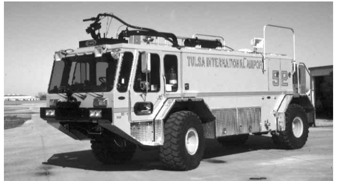
Figura 2.17b Típico vehículo de intervención rápida para el rescate y la lucha contra incendios en aeronaves.
