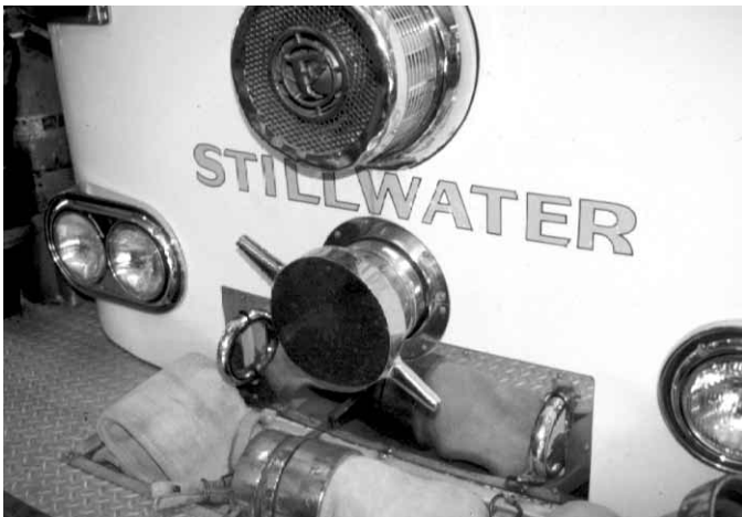
Figura 10.41 Las tomas delanteras o traseras de las bombas maestras son en realidad tomas auxiliares
