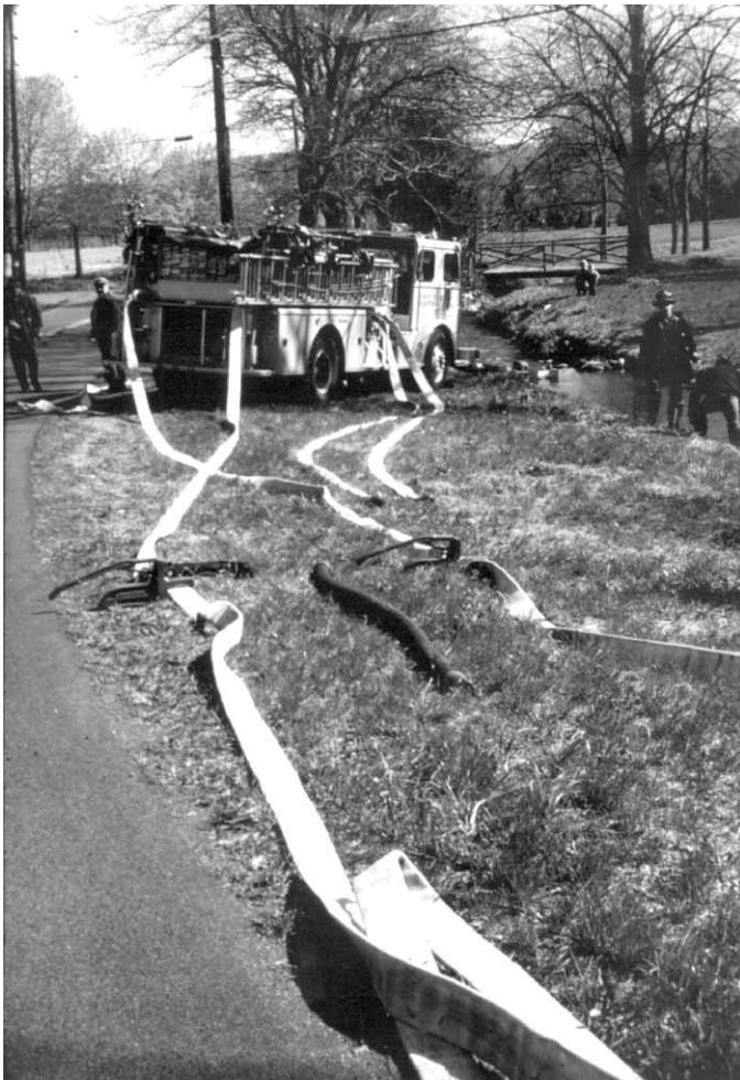
Figura 14.35 Pueden utilizarse abrazaderas para mangueras sobre las líneas de llenado.
