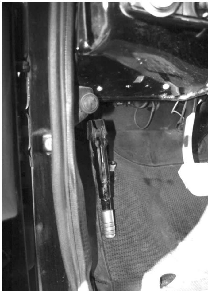
Figura 11.2 Algunos vehículos poseen frenos de mano de palanca.
