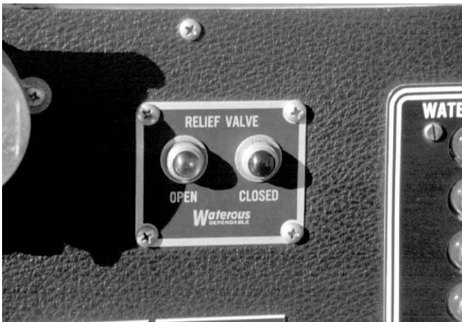
Figura 10.54 Cuando el sistema de control de presión está activo, se ilumina una luz amarilla.
