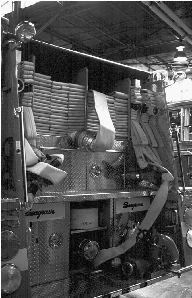
Figura 3.19 Revise el acomodo de mangueras para asegurarse de que el terminado se corresponde con los procedimientos de actuación normalizados.
