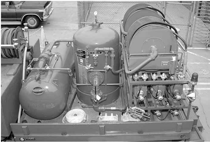
Figura 15.6 La espuma suele premezclarse en unidades de agente doble montadas sobre patines. Gentileza de Conoco Oil Co.
