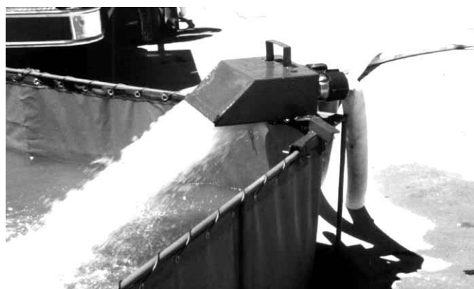
Figura 14.44b Algunos dispositivos especiales de descarga para las actuaciones de llenado de depósitos portátiles en las que se utiliza el bombeo directo.
