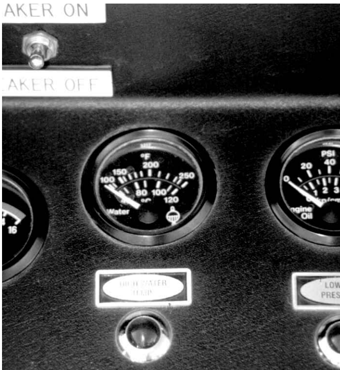
Figura 10.73 En caso de producirse un recalentamiento del motor, el indicador de la temperatura del líquido refrigerante del motor alerta al operario de la bomba.
