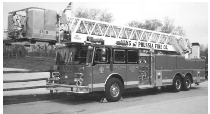
Figura 2.20b Las plataformas elevadizas suelen disponer de bombas contraincendios para mejorar la eficacia en las actuaciones con chorros maestros elevados.
