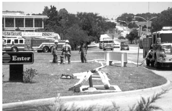
Figura 5.20 El autobomba se conecta tanto a la fuente de abastecimiento de agua como a la conexión del cuerpo de bomberos.
