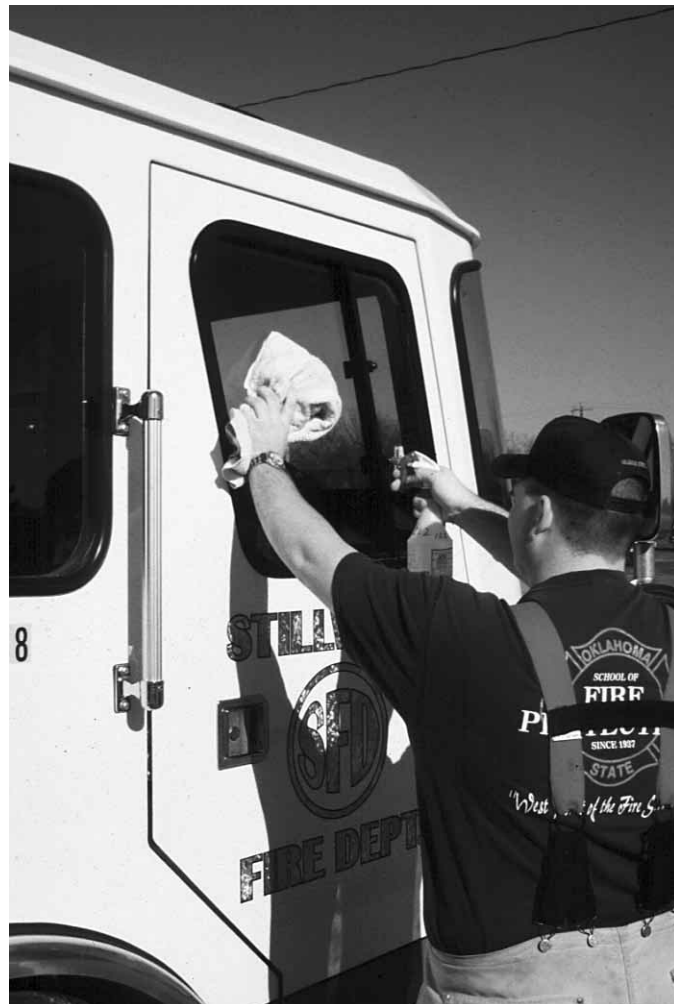
Figura 3.4 Para limpiar los cristales del vehículo, utilice agua caliente con jabón o limpiacristales comerciales.
