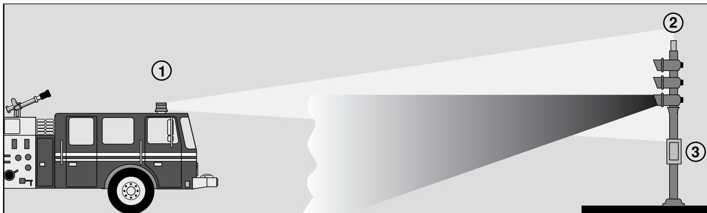
Figura 4.51 Funcionamiento del Opticom™: (1) el emisor genera una señal óptica hacia el detector (2), que convierte esa señal óptica en un impulso electrónico. El selector de fase (3) en la caja de control la procesa y manipula el controlador para que cambie el semáforo del vehículo de emergencia a verde y los semáforos en las otras direcciones a rojo. Gentileza de 3M Safety and Security.
