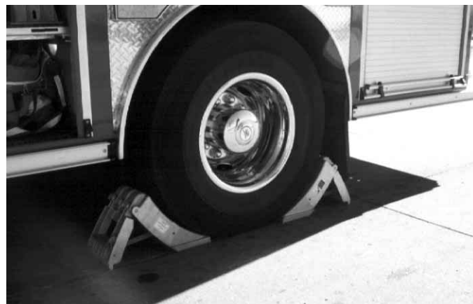
Figura 11.4 Es necesario bloquear las ruedas del vehículo durante las actuaciones de bombeo.
