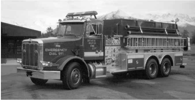
Figura 14.6b Los camiones cisterna rectangulares se parecen a los autobombas del cuerpo de bomberos y, de hecho, pueden utilizarse como tales.
