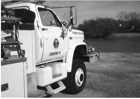
Figura 5.23a Detenga el autobomba cerca del lugar donde se realizará la succión.
