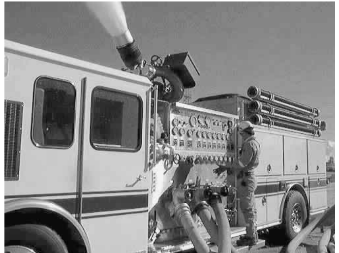
Figura 10.42 Los autobombas que pueden transportar grandes cantidades de agua, como este autobomba industrial de 12.000 L/min (3.000 gpm), disponen de múltiples tomas de gran tamaño a cada lado del vehículo. Gentileza de Celanese Corp., Clear Lake, instalación de Texas (EE.UU.).
