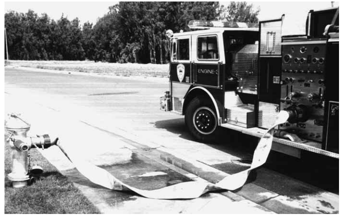
Figura 5.33 A menos que se utilicen coples Storz, se deben hacer dos giros completos en la manguera.
