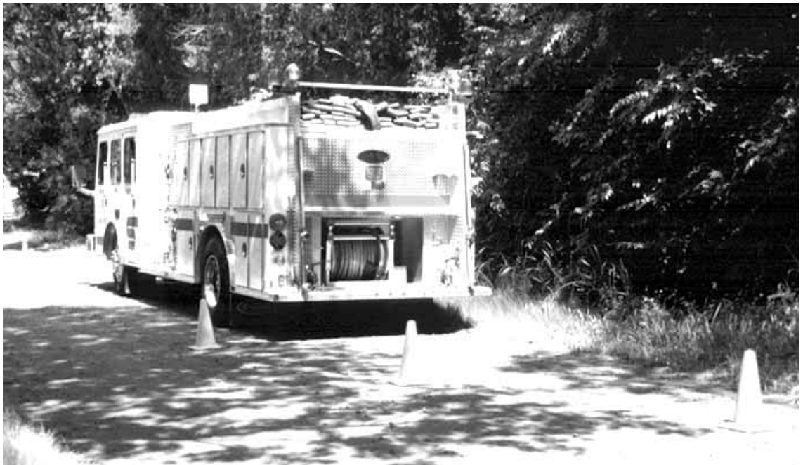
Figura 5.79 Pueden utilizarse conos de tráfico para alejar a los vehículos que se aproximan.
