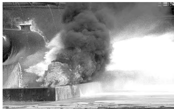
Figura 15.46 Aplicación de espuma mediante el método de caída.
