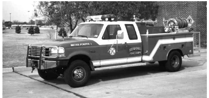
Figura 2.11b Los vehículos pequeños contra incendios forestales suelen estar montados sobre un bastidor de camión de una tonelada.
