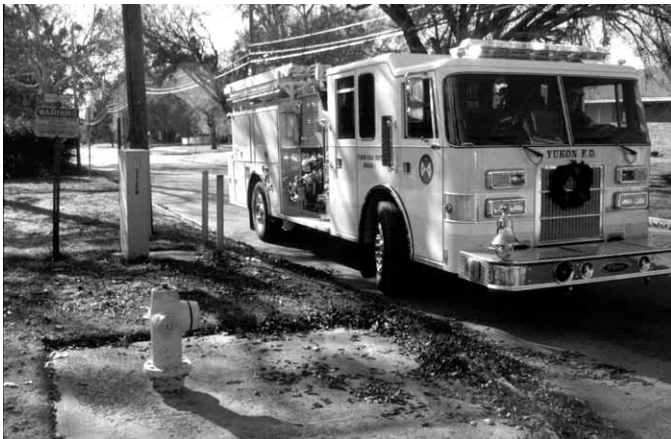
Figura 5.32 Detenga el vehículo de modo que la toma quede colocada a unos cuantos metros (pies) del hidrante.
