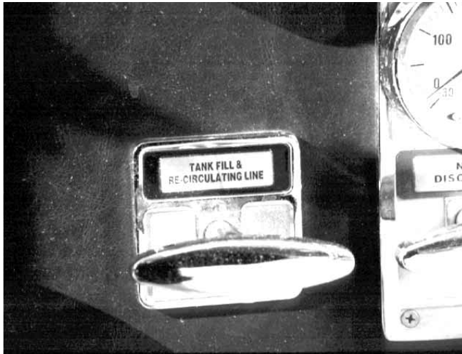
Figura 10.46 La línea de llenado del depósito se acciona mediante un controlador en el panel de la bomba.
