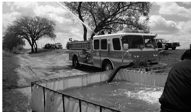
Figura 12.1 La succión es el proceso por el cual un autobomba extrae agua de una fuente estática de abastecimiento de agua.
