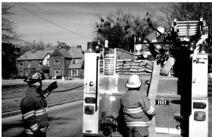
Figura 4.28 Los bomberos deben permanecer sentados o arrodillados en el área de la cama de la manguera.
