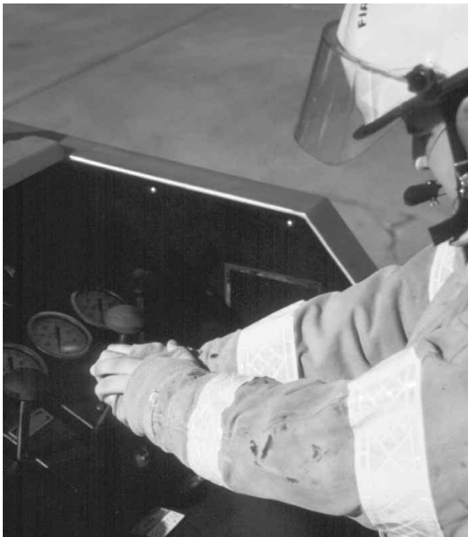
Figura 11.14 Cuando ya se ha creado la presión adecuada, se abre la descarga apropiada.
