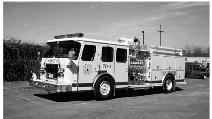
Figura 2.3b Los autobombas de instalaciones industriales suelen disponer de depósitos para el concentrado de espuma y sistemas de dosificación grandes. Gentileza de Ron Jeffers.
