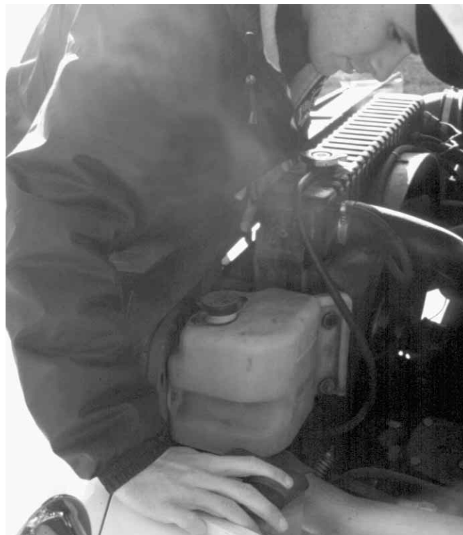
Figura 3.32 Es mejor comprobar el nivel de refrigerante cuando el motor está en frío.
