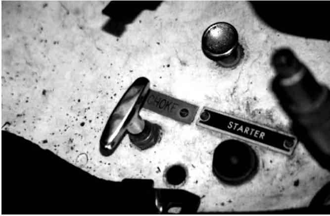
Figura 4.16 Los vehículos con motor de gasolina pueden tener un dispositivo de arranque en frío manual.
