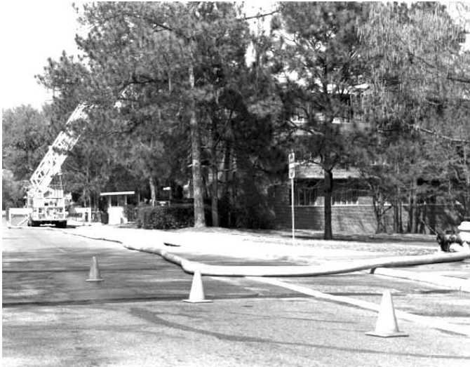
Figura 11.22 El vehículo que ha realizado el tendido hacia el incendio recibe la presión del hidrante. Gentileza de Rescate de incendios de Gainesville (Florida, EE.UU).
