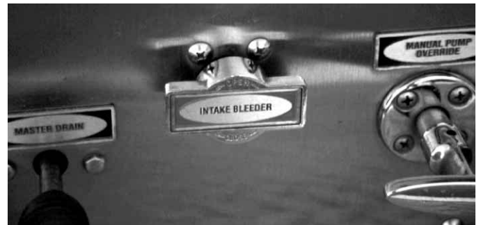
Figura 11.16 Abra la válvula de purga en la toma conmutada para eliminar el aire del sistema.
