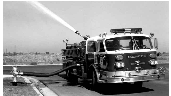
Figura 5.41 El primer autobomba se conecta al hidrante y empieza a descargar agua. Nota: en las fotos de esta secuencia se utiliza una manguera rígida de toma para realizar esta tarea. Las mangueras rígidas de toma sólo deben utilizarse con presiones positivas.
