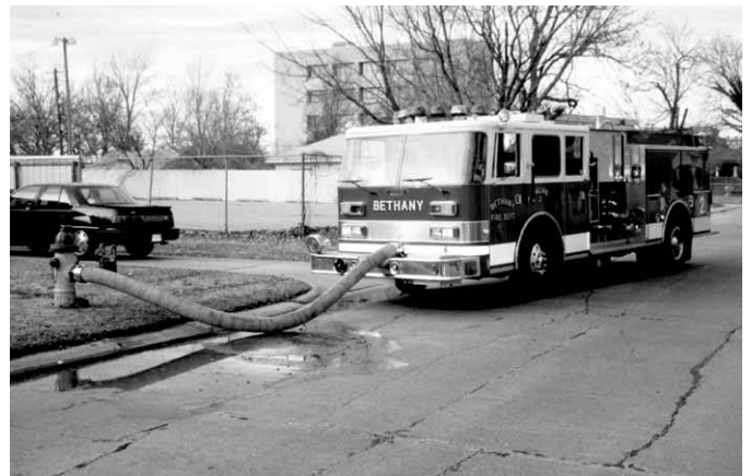
Figura 5.34 Detenga el vehículo de modo que la toma delantera quede colocada a unos cuantos metros (pies) del hidrante.
