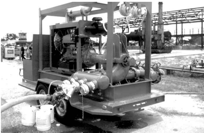
Figura 10.29 Las bombas montadas en remolques disponen de motores auxiliares.
