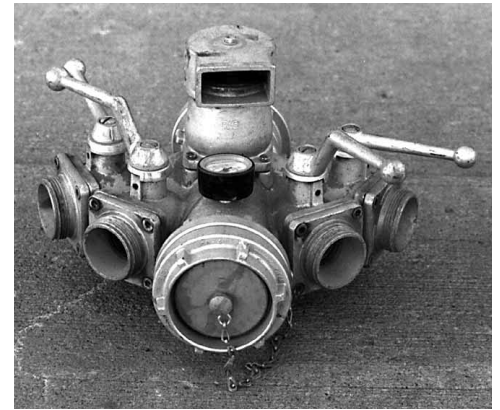
Figura 13.11 Cuadro de válvulas para mangueras de gran diámetro.
