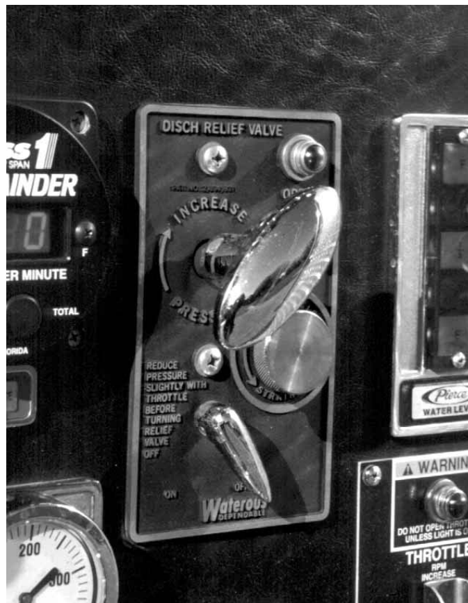
Figura 10.55 La válvula de control para liberar la presión suele colocarse en el panel de la bomba.
