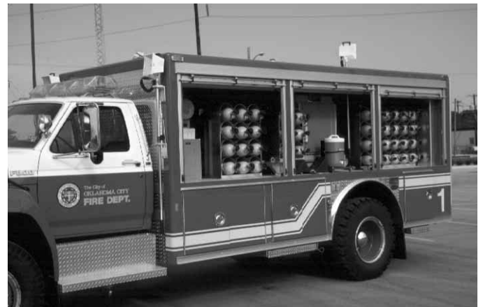
Figura 5.64 Los vehículos de abastecimiento de aire se envían a incidentes en los que es necesario utilizar y rellenar muchos cilindros de aire de los aparatos de respiración autónoma.
