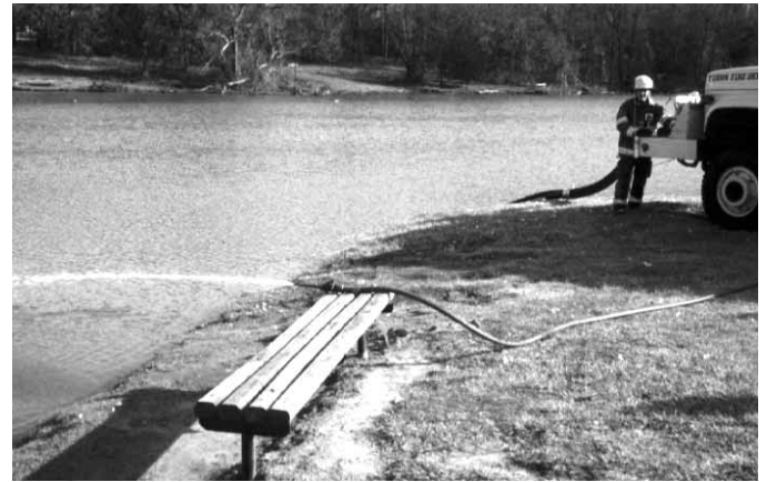
Figura 13.16 El autobomba de abastecimiento debe mantener una línea residual abierta para garantizar que no se pierde el cebado.
