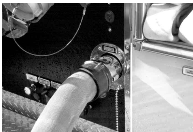
Figura 5.38 Las mangueras de abastecimiento de diámetro mediano suelen estar conectadas a las tomas conmutadas de 65 mm (2,5 pulgadas).
