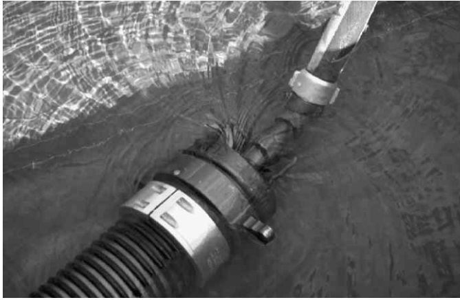
Figura 14.54 El extremo de la manguera unido al sifón se coloca en el depósito desde el cual se transfiere el agua.
