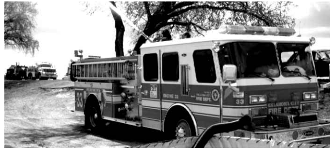
Figura 14.3 El autobomba del lugar de vaciado puede abastecer directamente a las líneas de ataque o realizar un bombeo en serie hasta un autobomba de ataque situado en el lugar del incendio.
