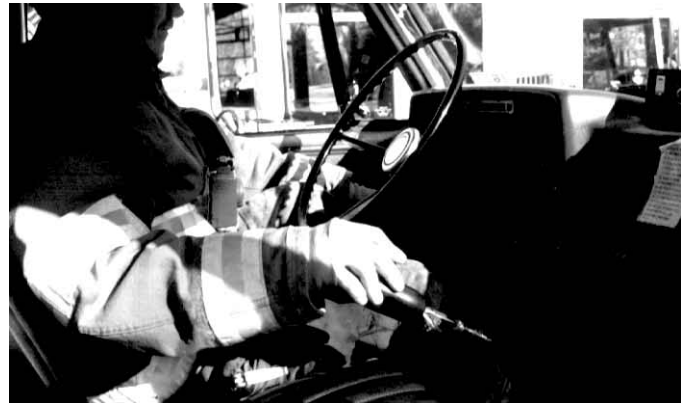
Figura 11.8 Deje la transmisión en punto muerto pisando el embrague con el pie izquierdo y moviendo la palanca de cambio para ponerlo en la marcha adecuada.
