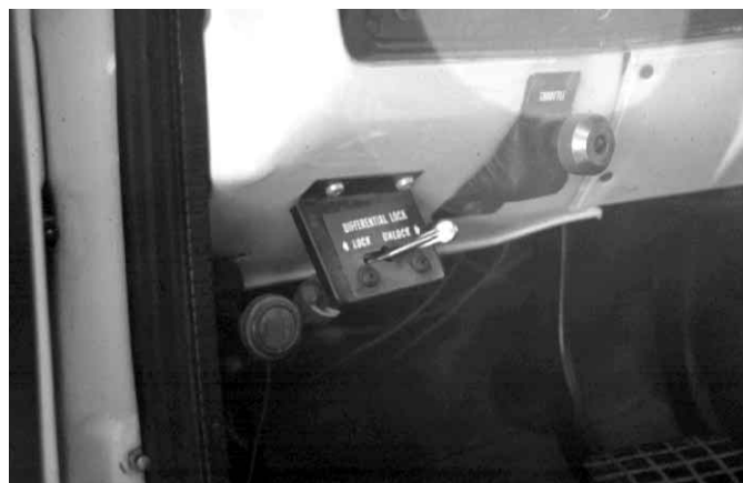
Figura 4.40 Los interruptores del bloqueo diferencial entre ejes pueden encontrarse en vehículos con ejes traseros en tándem.
