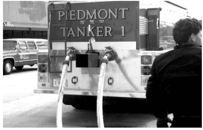
Figura 14.13a Algunas entradas montadas directamente en el depósito se encuentran en la parte inferior de éste.
