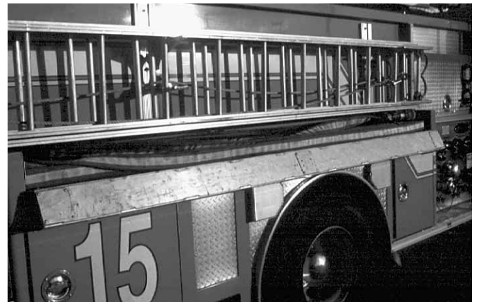
Figura 3.16b Algunos cuerpos de bomberos guardan las líneas de mano preconectadas en compartimentos especiales sobre el guardabarros de las ruedas traseras.
