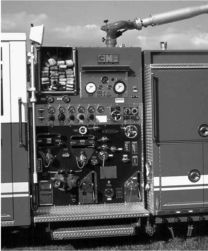
Figura 3.40 Asegúrese de que todos los controles e indicadores del panel de la bomba funcionan correctamente. Gentileza de Joel Woods.
