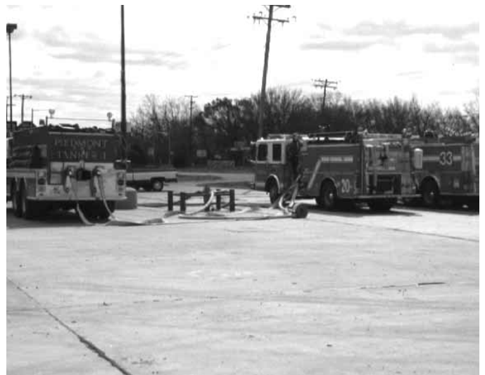
Figura 14.39 Si el espacio lo permite, se puede conectar un segundo camión cisterna a las mangueras de llenado mientras se carga el primero.
