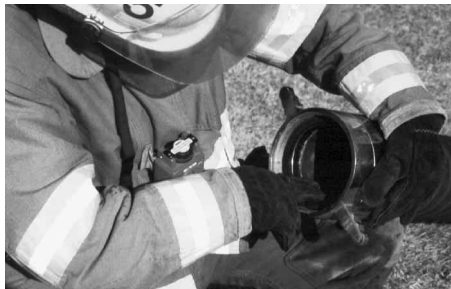
Figura 11.46 Asegúrese de que las juntas están en su lugar y en buen estado.
