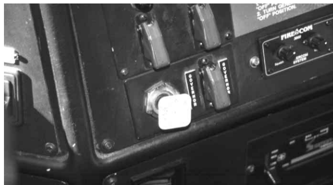
Figura 11.1 Los vehículos con frenos neumáticos suelen tener mandos presión-control amarillos.
