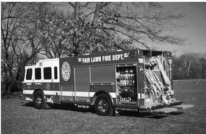
Figura 10.36 Las bombas montadas en la parte trasera han ganado aceptación en los últimos años. Gentileza de Ron Jeffers.
