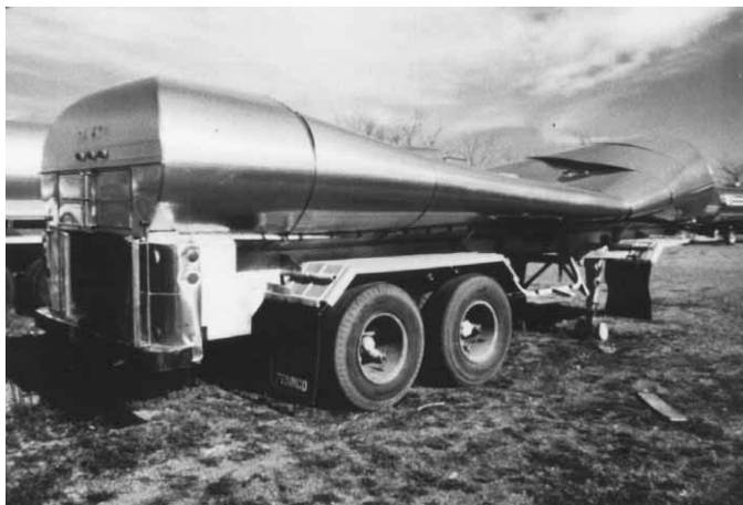
Figura 14.20 Aunque se trata de un camión cisterna para transportar leche, esta foto muestra los daños que puede ocasionar el hecho de que un depósito no disponga de la ventilación adecuada mientras se vacía. Gentileza de David Grupp.
