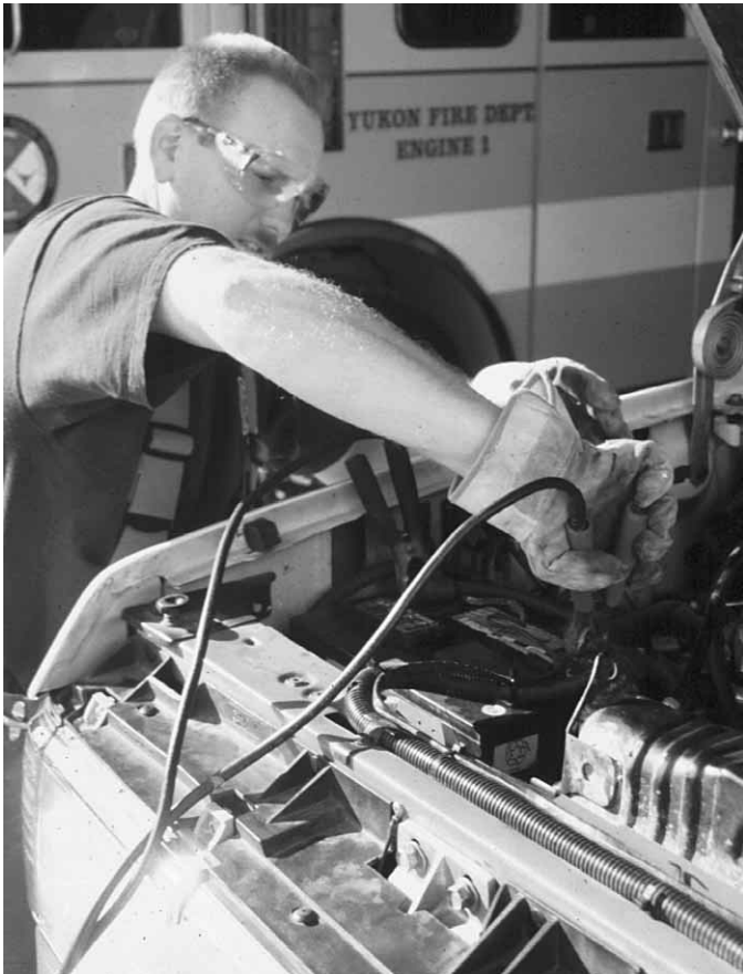
Figura 3.38 Conecte el cable del cargador rojo al borne rojo (+) de la batería.
