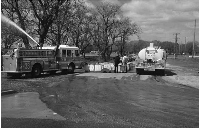
Figura 14.1 Las actuaciones de trasvase de agua se utilizan cuando no es posible efectuar una actuación de bombeo en serie.
