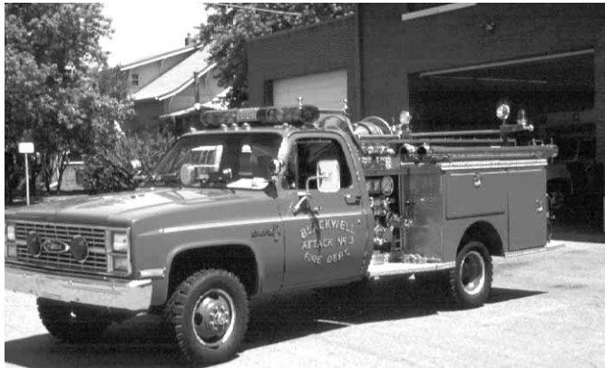
Figura 2.6 Las autobombas de ataque inicial pequeños están montados sobre un bastidor ligero de camión.
