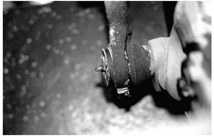
Figura 3.37 Lubrique el bastidor poniendo grasa en todos los elementos que la necesiten.
