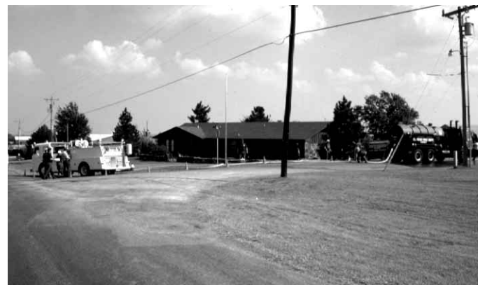
Figura 14.25 Los lugares de llenado en los que los camiones pueden entrar por un lado y salir por otro son excelentes para las actuaciones de trasvase.
