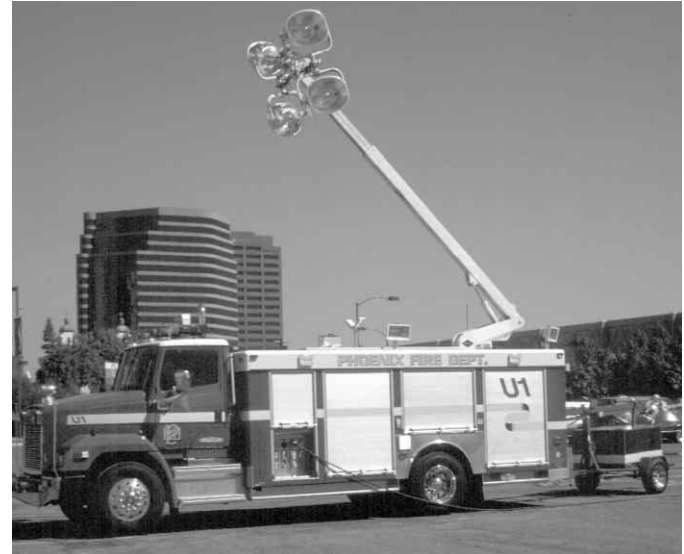
Figura 2.28 Los grupos más complejos de lámparas suelen elevarse mecánicamente.
