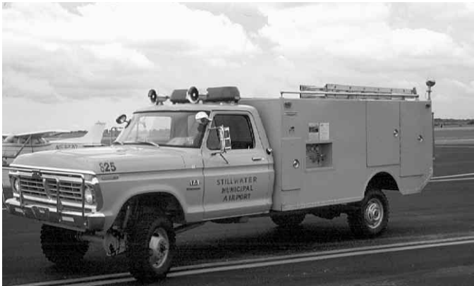
Figura 2.18a Los vehículos de agente combinado transportan agentes extintores de polvo químico seco y espuma.
