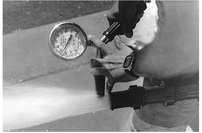
Figura 16.18 El tubo de Pitot debe estar en el centro del chorro de agua.
