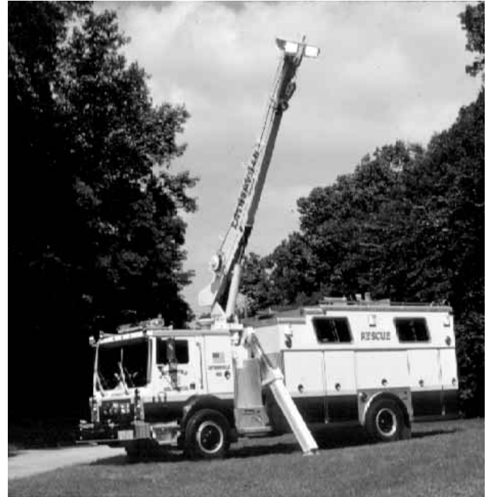
Figura 5.60 Las compañías de rescate suelen utilizarse para iluminar las actuaciones nocturnas. Este vehículo de rescate está equipado con luces en el extremo de la grúa hidráulica para proporcionar iluminación elevada. Gentileza de Joel Woods.
