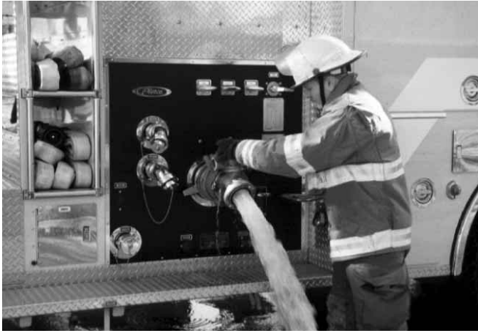
Figura 11.43 La bomba debe aclararse a fondo con agua después de la succión.
