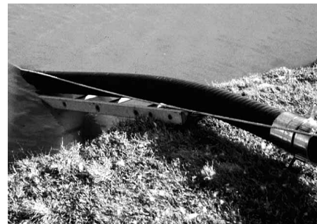
Figura 5.26 En algunos casos, puede ser recomendable tender la manguera de toma sobre una escala.
