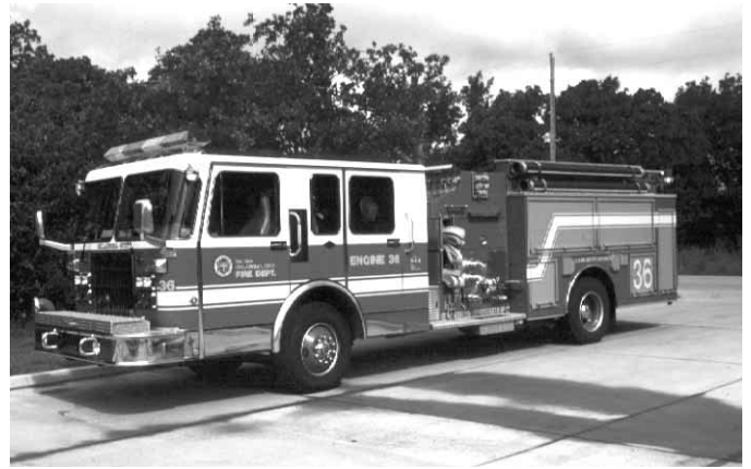
Figura 5.74 Los autobombas con paneles de la bomba montados en la parte superior son más recomendables para los incidentes en autopistas.
