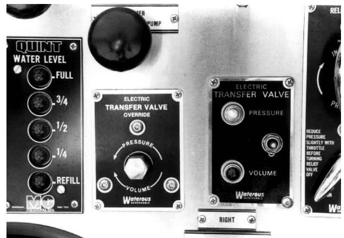
Figura 10.22 La válvula de conmutación sirve para cambiar de la posición de volumen a la de presión.
