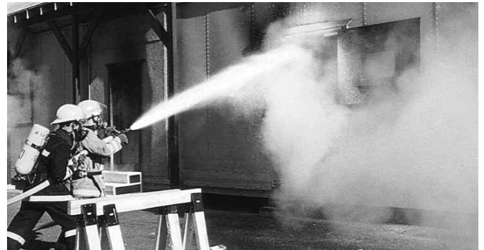
Figura 15.34b Los chorros procedentes de un sistema de espuma de aire comprimido a través de una boquilla de chorro directo son una herramienta poderosa. Gentileza del Distrito de protección contraincendios de Mount Shasta, California (EE.UU.).
