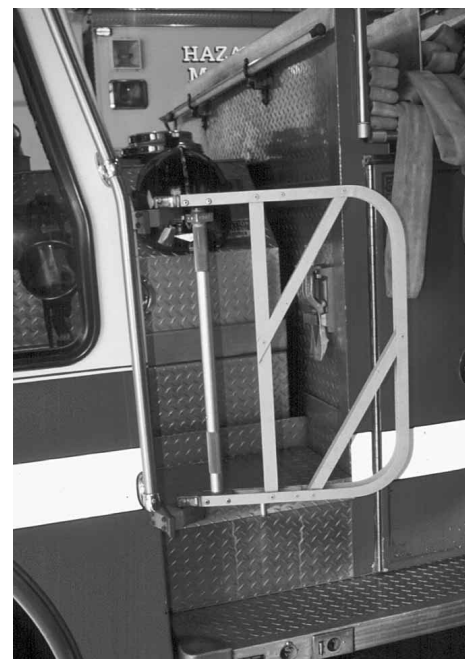
Figura 4.30b Las puertas de seguridad proporcionan una mayor protección que las barras.
