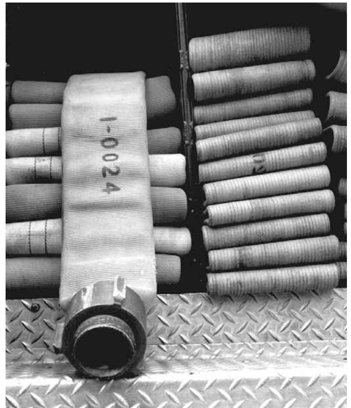
Figura 11.28 Si se utilizan coples roscados para mangueras, el cople macho debe salir primero de la cama de mangueras para realizar un tendido hacia la fuente de abastecimiento.
