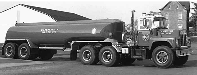
Figura 2.8c Las jurisdicciones con importantes problemas de abastecimiento de agua suelen utilizar camiones cisterna semirremolque grandes. Gentileza de Bob Esposito.
