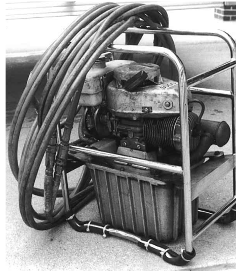
Figura 2.31a Los motores de las herramientas de rescate portátiles e hidráulicas suelen utilizar mangueras enrolladas.
