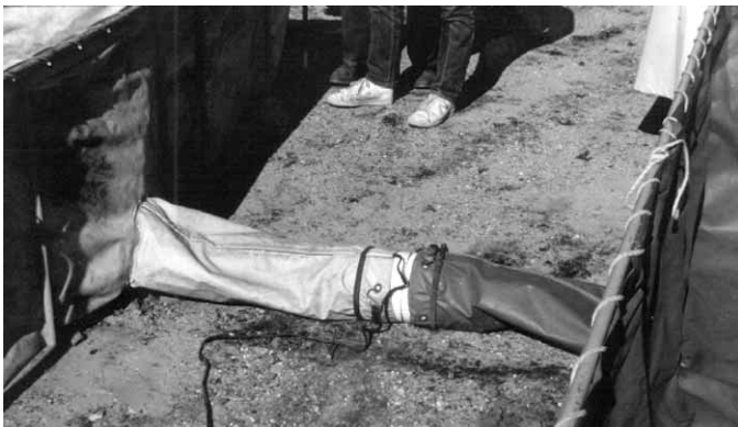
Figura 14.52 Pueden utilizarse conectores especiales para conectar las aperturas de drenaje de los depósitos.
