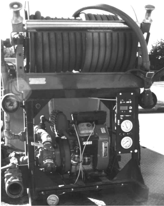
Figura 2.13 La mayoría de vehículos contra incendios forestales utiliza una bomba que funciona con un motor auxiliar.
