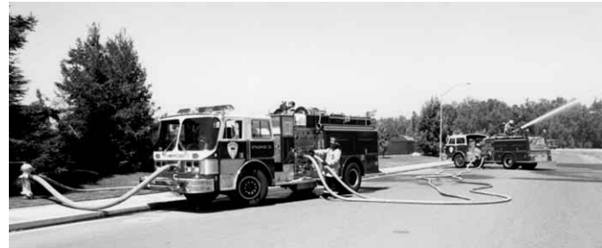
Figura 5.45 El bombeo en tándem es, en realidad, una variante a pequeña escala del bombeo en serie.
