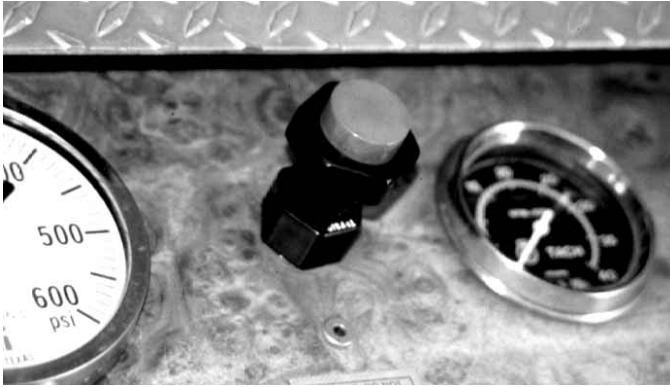
Figura 10.78 Este tipo de regulador de la aceleración se ha utilizado durante muchos años.
