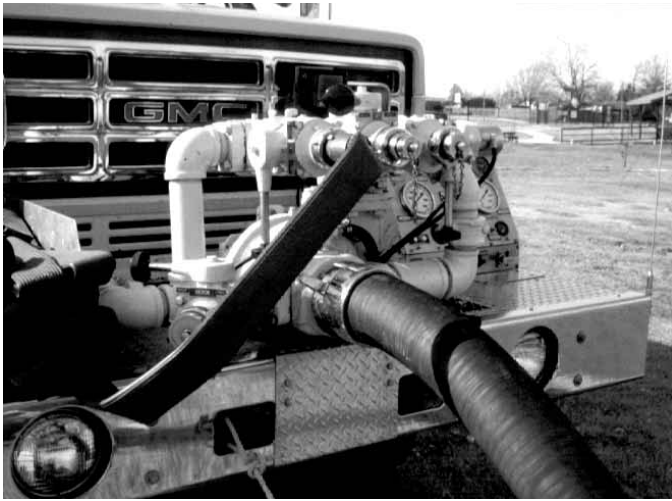
Figura 10.39 La toma principal de una bomba montada en la parte delantera sale de la parte inferior de la misma.
