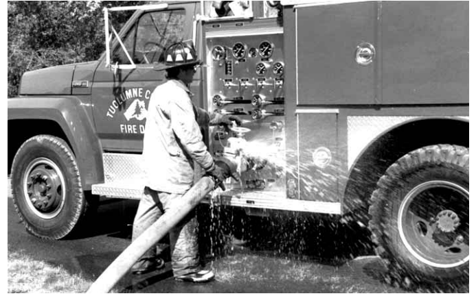
Figura 13.6 La válvula se acciona si se recibe exceso de presión en la toma.
