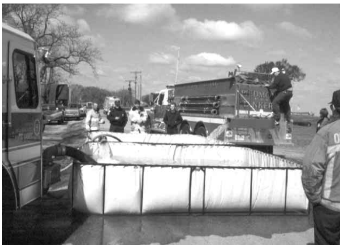
Figura 14.42 Los lugares de vaciado con depósitos portátiles son los más recomendables para las actuaciones con un abastecimiento continuo de agua.
