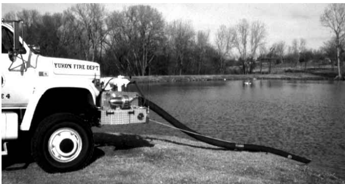
Figura 12.13 Es necesario que el terreno donde se sitúe el vehículo para realizar la succión sea seguro. Este lugar puede que sea seguro si el tiempo es seco, pero podría ser un problema si el terreno está húmedo.
