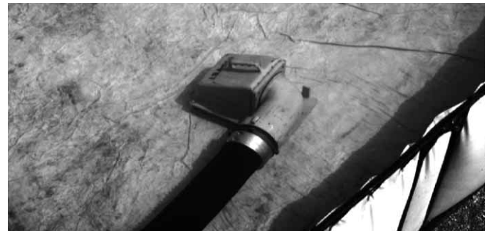
Figura 14.49 El filtro para niveles de agua bajos succionará agua hasta con profundidades de unos 50 mm (2 pulgadas).
