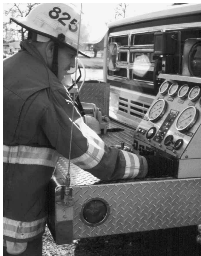
Figura 11.52 Cuando la manguera esté colocada en la posición correcta, debe accionar el control del cebador.
