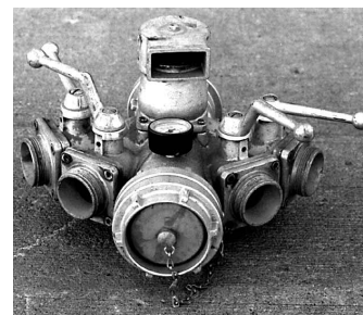
Figura 8.22b Cuadro de válvulas para mangueras de diámetro grande.
