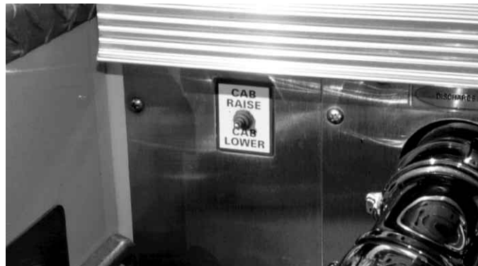
Figura 3.28 El mecanismo de control de la cabina basculante debe activarse antes de reclinar la cabina.
