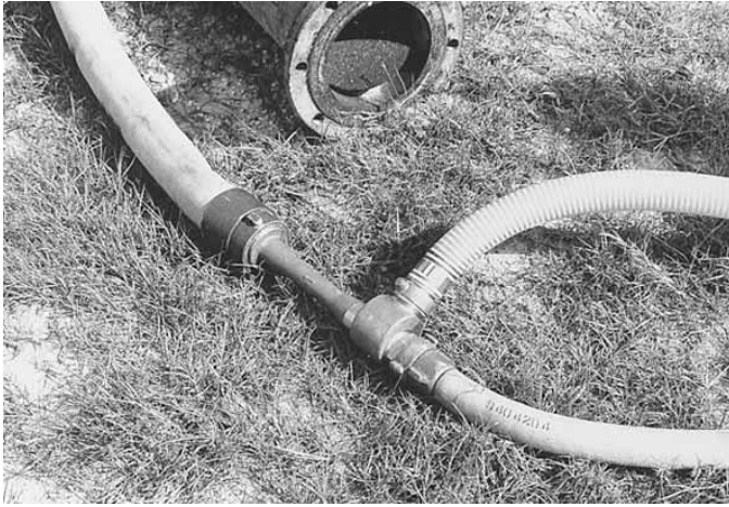
Figura 15.25 El controlador de proporción de chorro se parece a un tubo eductor de espuma alineado.
