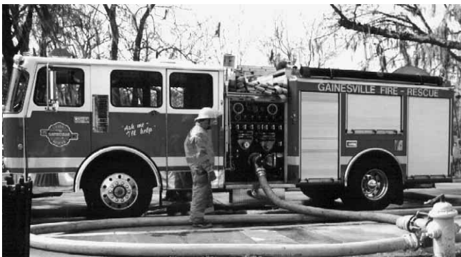
Figura 11.18 En áreas urbanas y suburbanas, las autobombas suelen funcionar conectados a hidrantes. Gentileza de Rescate de incendios de Gainesville (Florida, EE.UU.).
