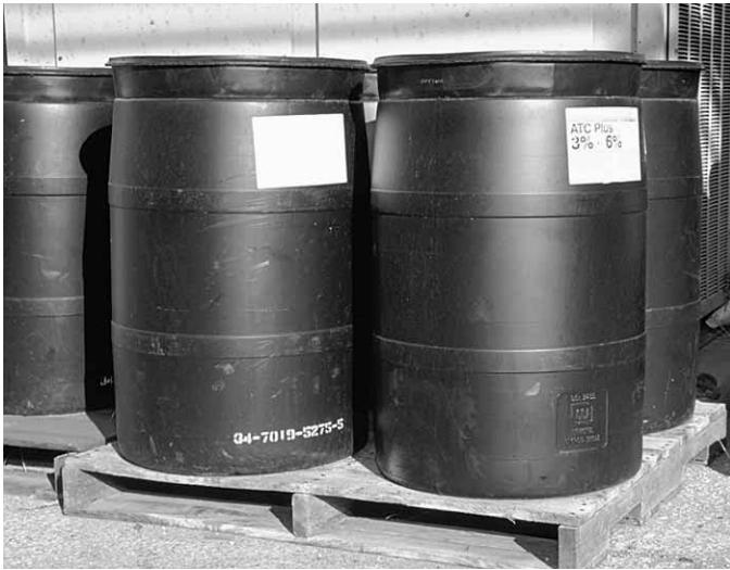
Figura 15.8 Las organizaciones que utilizan grandes cantidades de espuma pueden comprar concentrado de espuma en barriles de 220 L (55 galones). Gentileza de Conoco Oil Co.
