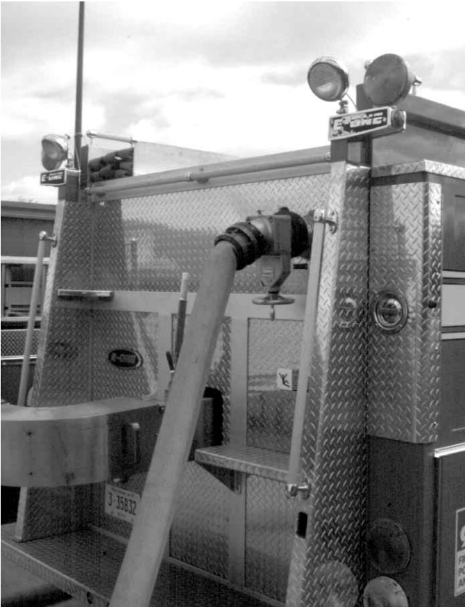
Figura 14.12 Algunas jurisdicciones utilizan una línea de mangueras de gran diámetro para llenar los camiones cisterna.
