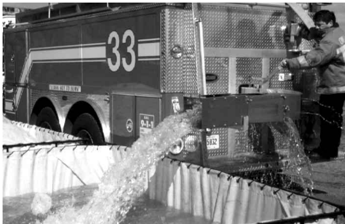
Figura 14.45 El modo más rápido para llenar un depósito portátil es vaciar la carga del camión cisterna a través de una válvula de descarga montada directamente en el depósito.
