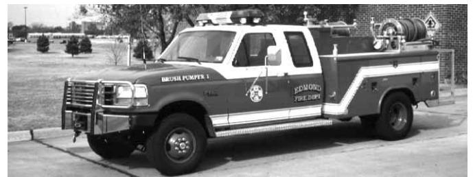
Figura 2.1b Autobomba montado sobre el bastidor de un camión comercial. Gentileza de Warren Gleitsmann.
