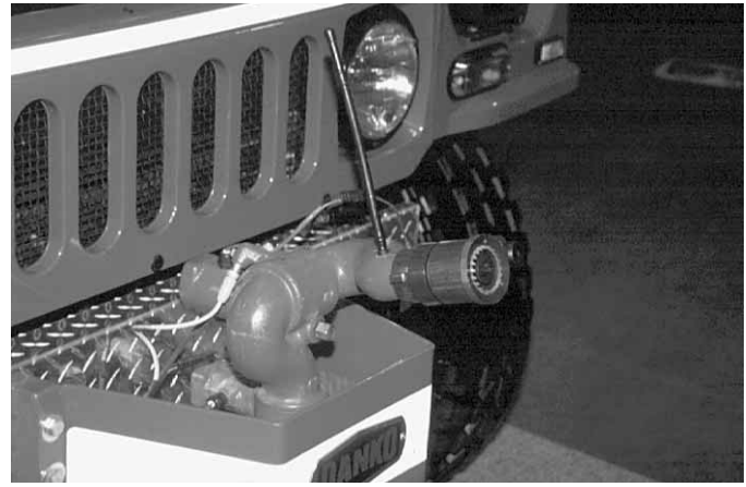
Figura 2.14 Las boquillas controladas a distancia ubicadas en el parachoques delantero eliminan la necesidad de ir montado en el exterior del vehículo durante las actuaciones de bombeo en movimiento.
