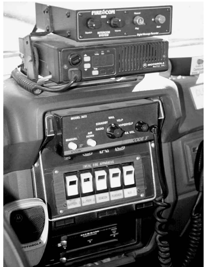
Figura 3.24 Asegúrese de que los controles de radio y de la sirena están bien configurados y de que funcionan correctamente.
