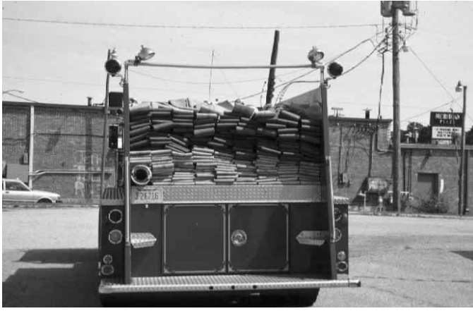
Figura 13.4 Los vehículos para mangueras suelen transportar más de mil metros (pies) de manguera de gran diámetro. Esta unidad transporta 1,6 km (1 milla) de manguera de 125 mm (5 pulgadas).
