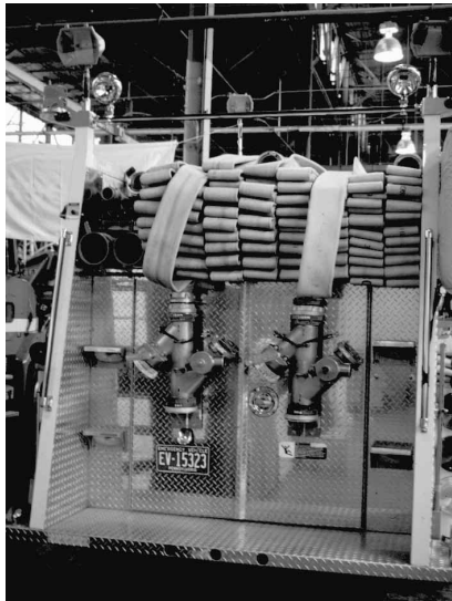
Figura 13.8b Algunas jurisdicciones preconectan las válvulas para el bombeo en serie a las mangueras colocadas en la cama del vehículo.
