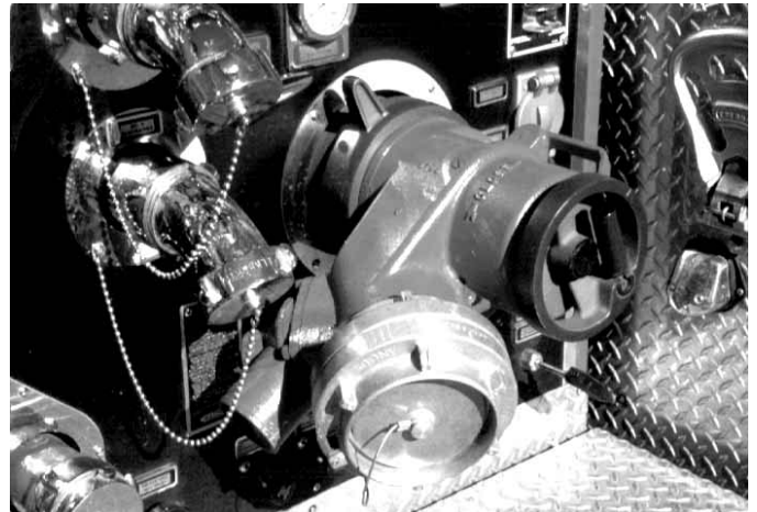
Figura 10.52a Las válvulas de compuerta de la toma pueden estar equipadas con una ruedecita de mano.
