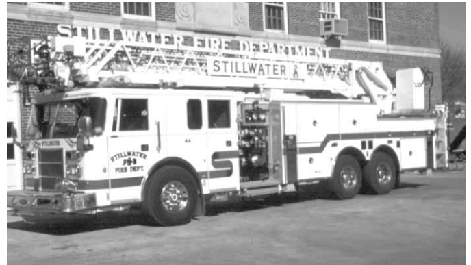
Figura 2.20a Muchos vehículos con escalas elevadizas están equipados con bombas contraincendios.
