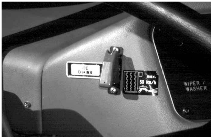
Figura 4.44 Las cadenas para neumáticos automáticas se activan con un interruptor que se encuentra en la cabina.
