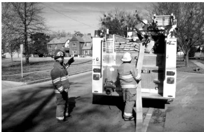
Figura 4.27 El vehículo circula hacia delante, al lado de la manguera o pasando sobre ella de modo que quede entre las ruedas derecha e izquierda.
