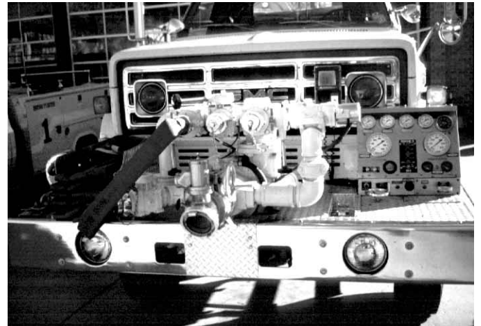
Figura 10.31 En algunas jurisdicciones son más habituales las bombas montadas en la parte delantera.
