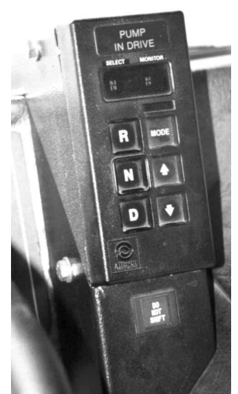
Figura 4.21 Esta transmisión automática funciona con pulsadores.
