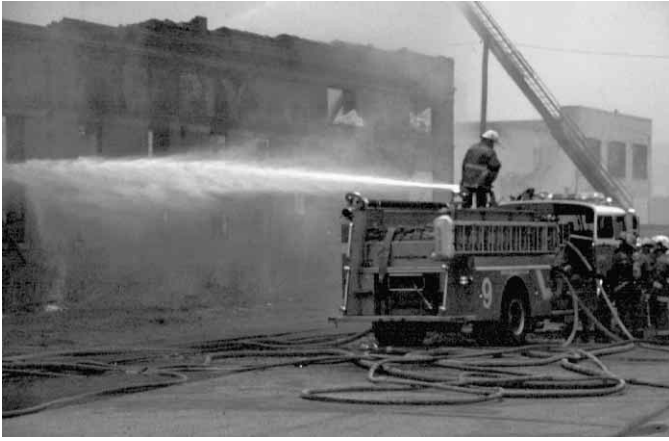
Figura 5.5 El chorro de la torre debe ser capaz de alcanzar el foco del incendio.
