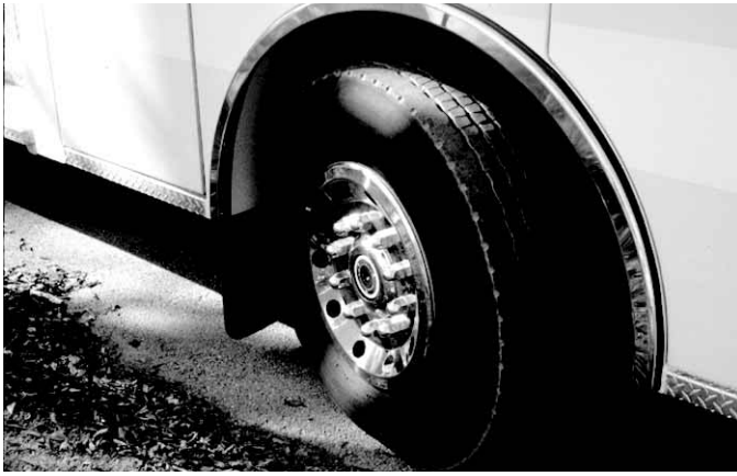
Figura 5.31 Las ruedas delanteras del vehículo tienen que formar un ángulo de 45° como mínimo al colocarse cerca de un hidrante.
