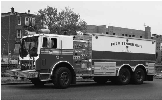
Figura 15.9 Algunas organizaciones poseen grandes vehículos que se utilizan principalmente para transportar grandes cantidades de concentrado de espuma. Gentileza de Ron Jeffers.
