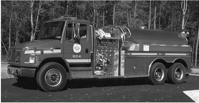
Figura 14.6a Los camiones con cisternas elípticas están diseñados únicamente para realizar trasvases de agua. Gentileza de Joel Woods.
