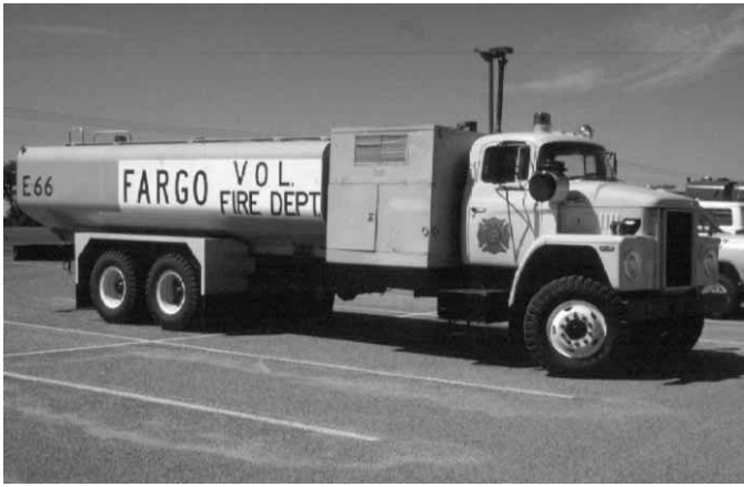
Figura 4.5 Los camiones cisterna para el agua que se construyen a partir de viejos camiones cisterna para leche o petróleo deben conducirse con precaución.
