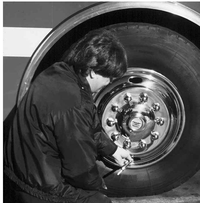
Figura 3.9 Revise los neumáticos para comprobar si están dañados y si el nivel de inflado es correcto.
