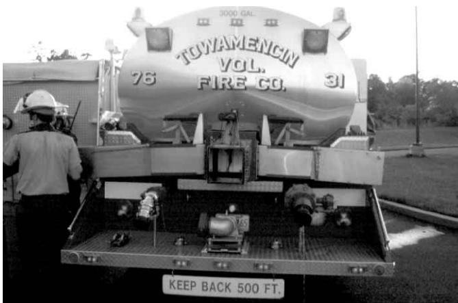
Figura 14.15 Esta válvula de vaciado puede ajustarse para descargar agua desde tres lados diferentes.
