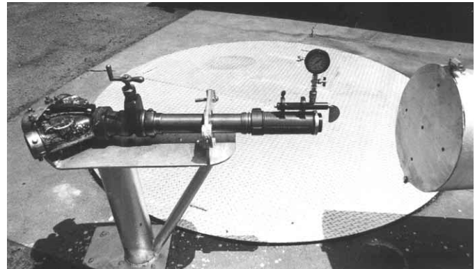
Figura 16.9b Algunos soportes para boquillas de prueba son fijos.
