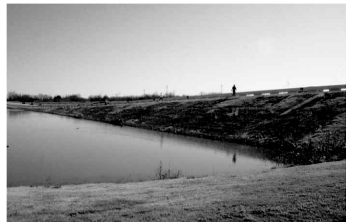
Figura 12.10 La profundidad de succión en la imagen sería inadecuada. Sin embargo, si el autobomba estuviera situado algunos centenares de metros (pies) por debajo del puente, la succión sería posible.
