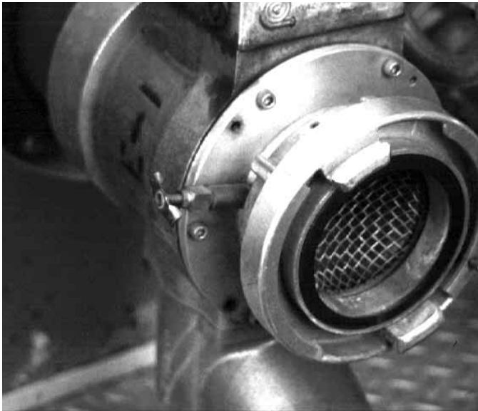
Figura 10.60 Las válvulas externas de liberación de presión disponen de válvulas de desahogo que permiten extraer el aire de la manguera sin que éste entre en la bomba.
