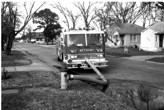
Figura 5.35 Para utilizar la toma delantera, el vehículo tiene que colocarse formando un ángulo de 45°.
