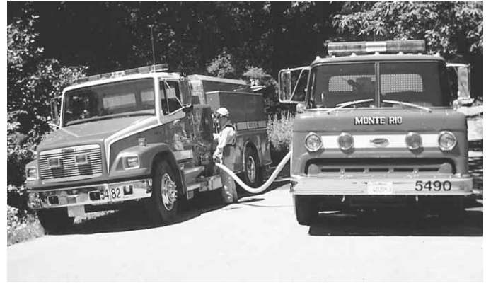
Figura 2.9 En algunas jurisdicciones, el camión cisterna y el autobomba de ataque están unidos directamente por un tramo corto de manguera. Esto se denomina operación de “cisterna nodriza”.
