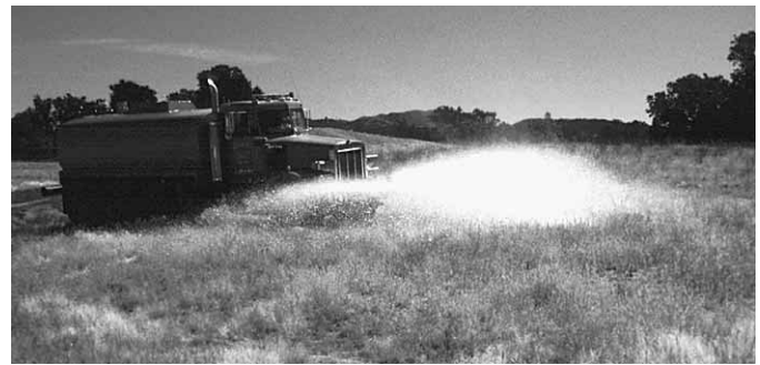
Figura 2.15 Las boquillas de barrido de suelo ayudan a proteger el bastidor del vehículo.
