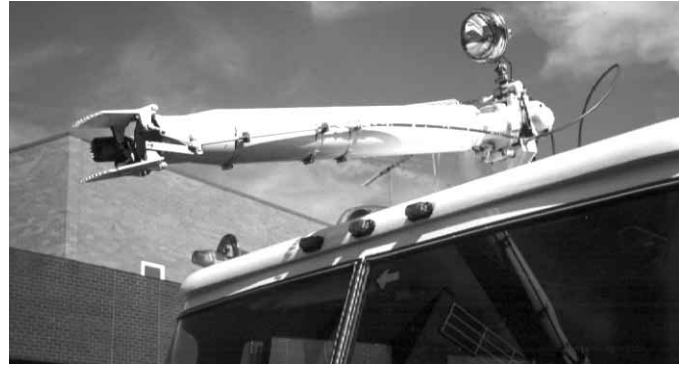
Figura 3.41a Algunos autobombas están equipados con torres de techo, como este autobomba con dispositivos para espuma.
