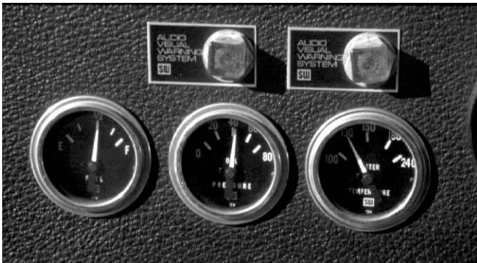
Figura 10.74 El panel de la bomba puede disponer de un indicador visual de recalentamiento.
