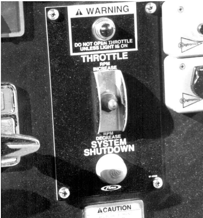
Figura 10.79 Los vehículos más modernos pueden estar equipados con reguladores de aceleración accionados con una palanca.
