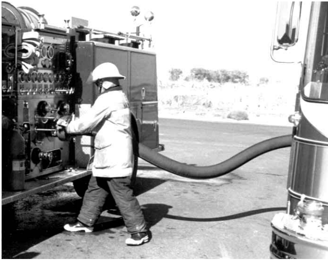
Figura 5.42 El segundo autobomba se puede conectar entonces a la toma mayor del primer autobomba. El proceso se agiliza con una válvula en esa toma.
