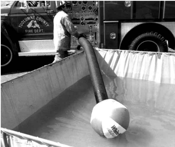
Figura 11.39 Puede utilizarse una pelota de playa, una botella de plástico tapada o algún objeto similar para que flote encima del filtro y evite la formación de torbellinos.
