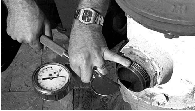
Figura 8.5a Para medir la presión de velocidad de un chorro de agua, se utilizan un tubo de Pitot y un manómetro.
