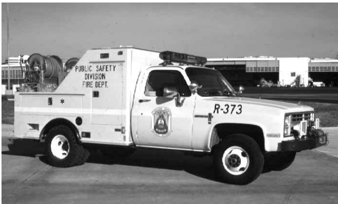
Figura 2.18b Vehículo de agente combinado para el rescate y la lucha contra incendios en aeronaves. Gentileza de Joel Woods.
