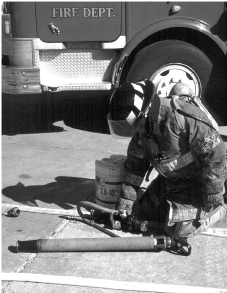
Figura 15.42 Compare el tubo eductor y la boquilla para asegurarse de que son compatibles.
