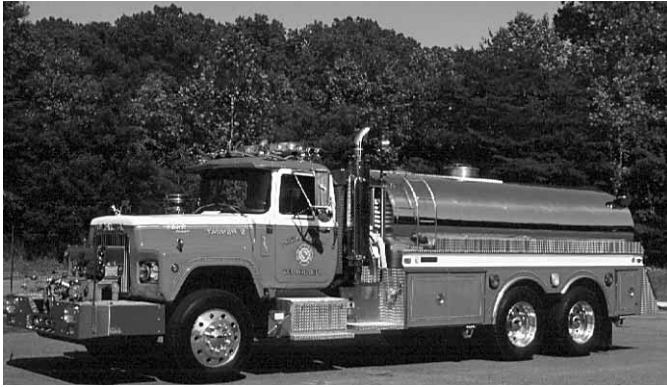
Figura 2.8a Las cisternas elípticas sólo están diseñadas para transportar agua hasta el lugar del incendio. Gentileza de Joel Woods.
