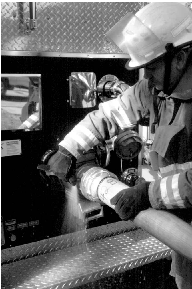
Figura 11.30 El aire procedente de la línea de abastecimiento puede eliminarse en la válvula de toma.
