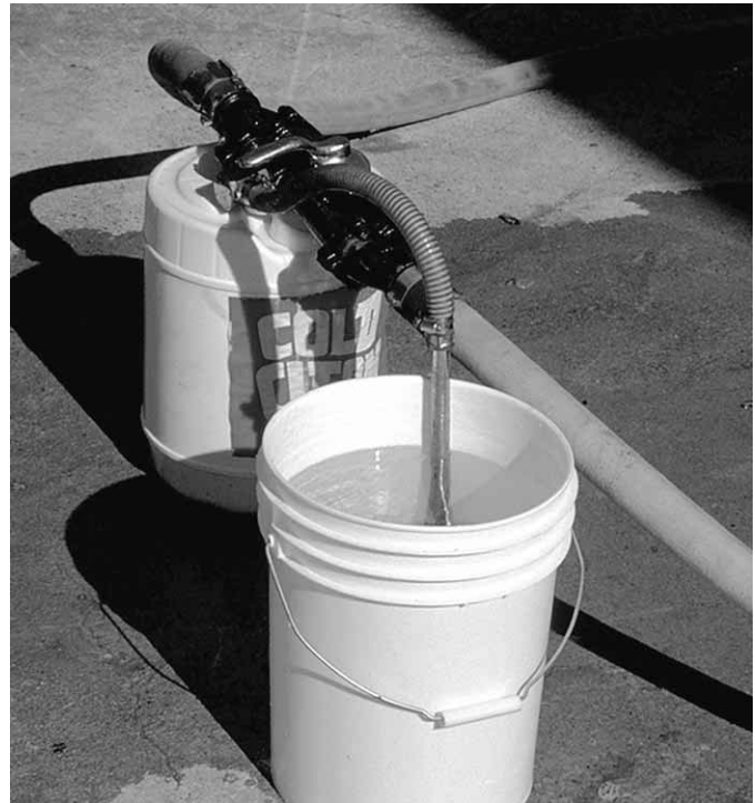
Figura 15.21 Aclare a fondo el tubo educador con agua limpia después de cada uso.
