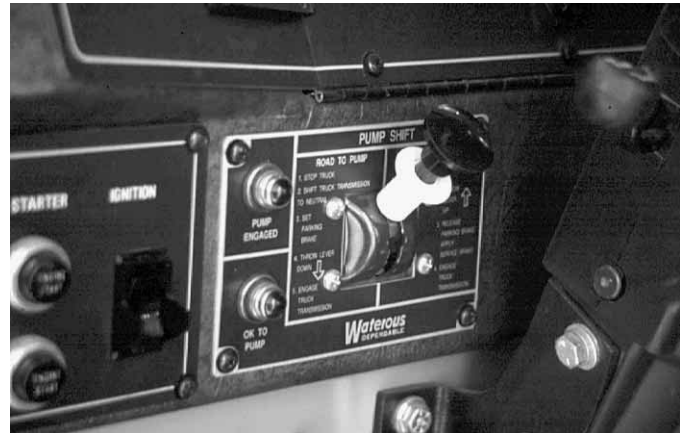
Figura 3.39 Ponga en marcha el control de accionamiento de la bomba y asegúrese de que la bomba puede ponerse en marcha.
