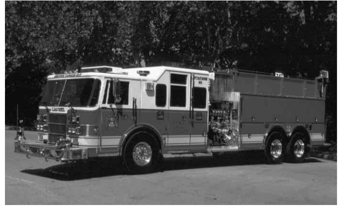
Figura 14.7 Los autobomba/camión cisterna pueden actuar como vehículo de trasvase o como vehículo de ataque. Gentileza de Joel Woods.
