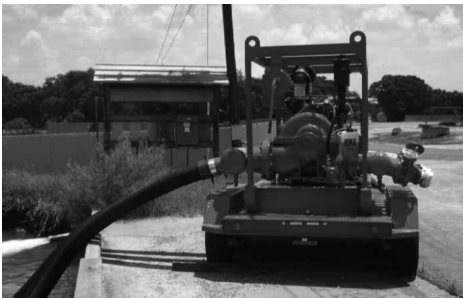
Figura 10.10 La bomba centrífuga es la más utilizada en el cuerpo de bomberos hoy en día.
