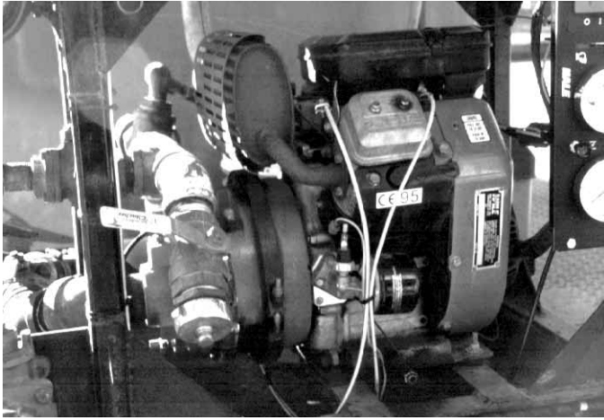
Figura 10.28 En los vehículos contra incendios forestales suelen utilizarse bombas con motores auxiliares.
