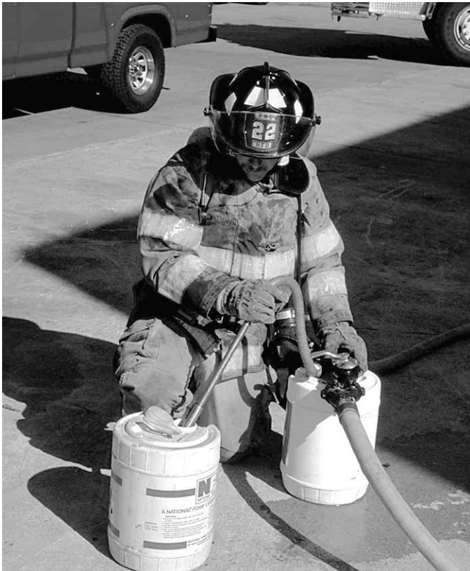
Figura 15.20 El tubo se coloca directamente en el bidón de espuma.
