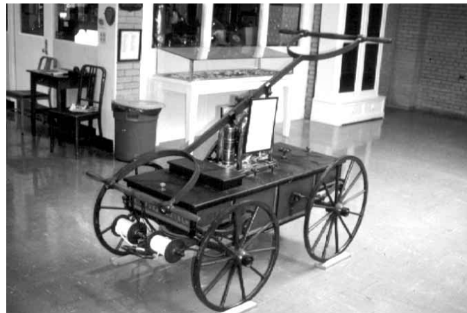
Figura 10.2 Algunos de los primeros autobombas disponían de bombas de émbolo manuales.
