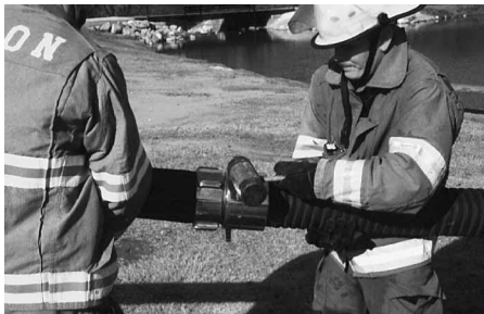
Figura 11.47 Puede que sea necesario golpear las orejas del cople con un martillo de goma para garantizar que la conexión es hermética.
