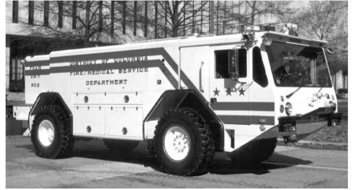
Figura 2.17a Los vehículos de intervención rápida para rescate y lucha contra incendios en aeronaves son menores que los vehículos principales de rescate y lucha contra incendios en aeronaves. Gentileza de Joel Woods.
