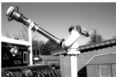
Figura 7.16a Este dispositivo de chorro maestro no puede retirarse del vehículo para utilizarlo.
