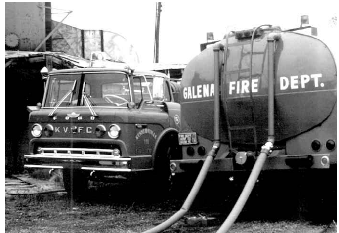
Figura 14.13b Algunas entradas montadas directamente en el depósito están conectadas con tuberías que llegan a la parte superior del depósito. Ninguno de los dos métodos presenta ventajas hidráulicas significativas sobre el otro.
