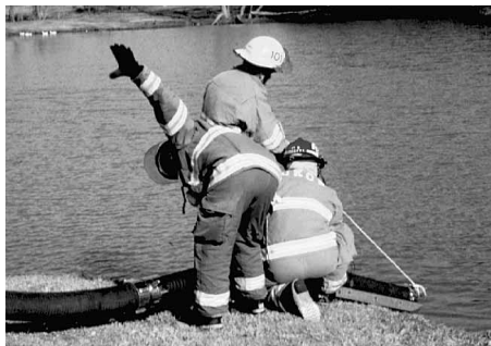
Figura 5.24 La cuerda atada al extremo de la manguera de toma ayuda a colocar la manguera.
