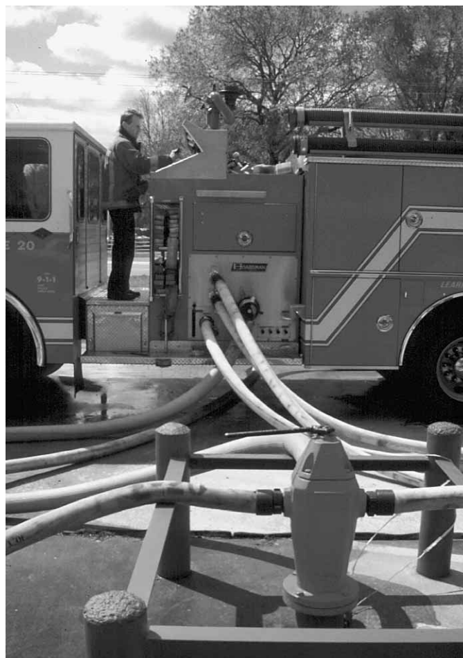
Figura 10.1 Con el fin de producir chorros contra incendios eficaces, es necesario incrementar las presiones existentes en las bombas contra incendios.
