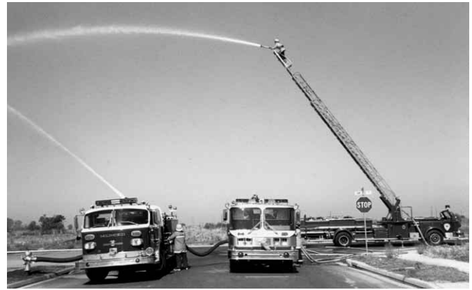
Figura 5.44 Los dos autobombas reciben agua del mismo hidrante.
