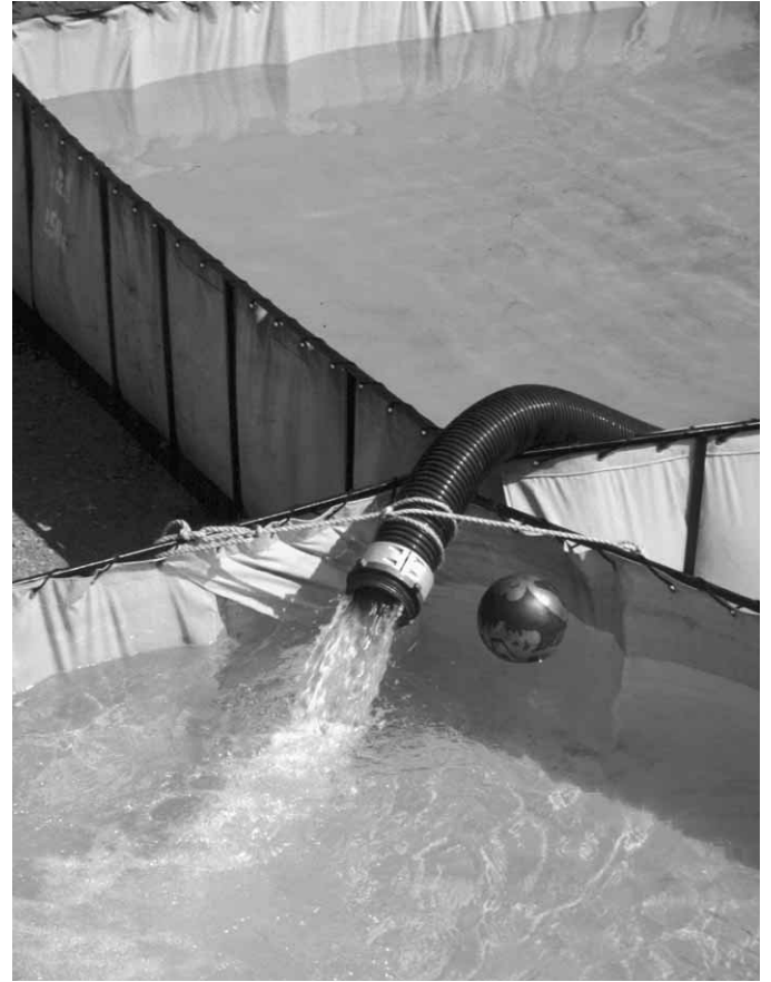
Figura 14.55 Cuando la línea de abastecimiento del sifón está cargada, se transfiere agua de un depósito al otro.
