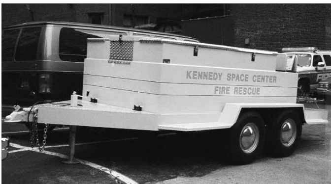
Figura 15.10 Las grandes cantidades de concentrado de espuma pueden colocarse en remolques especiales para espuma. Gentileza de Fire Wagons, Inc.
