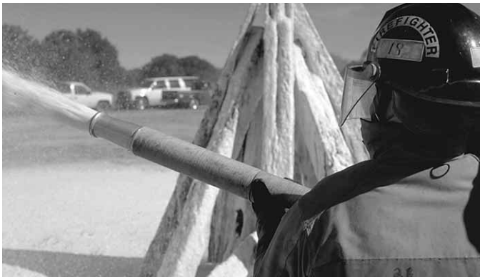
Figura 15.37 Boquilla típica de espuma aspiradora.
