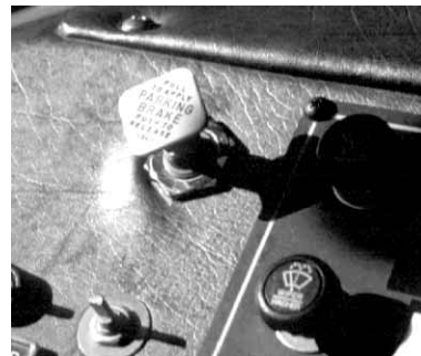
Figura 3.27 En los vehículos equipados con un sistema de frenado neumático, el control del freno de estacionamiento suele ser un interruptor que se estira o se empuja.
