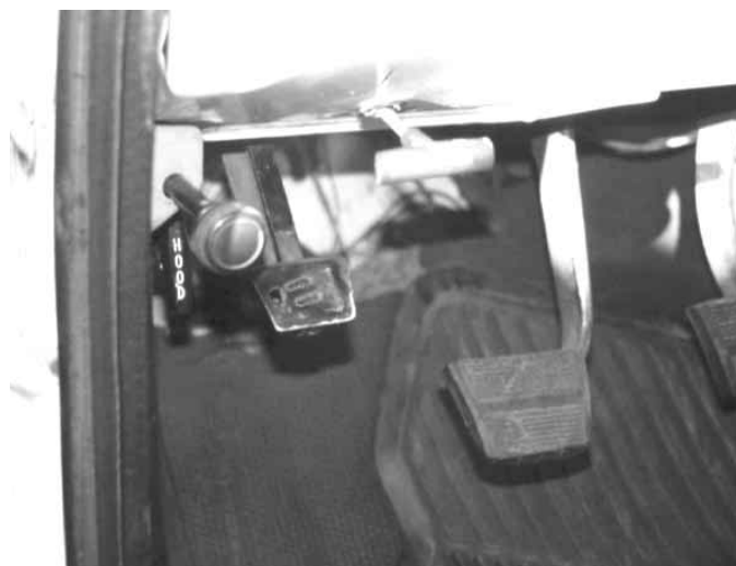
Figura 11.3 Los vehículos más pequeños poseen frenos de mano de pedal.
