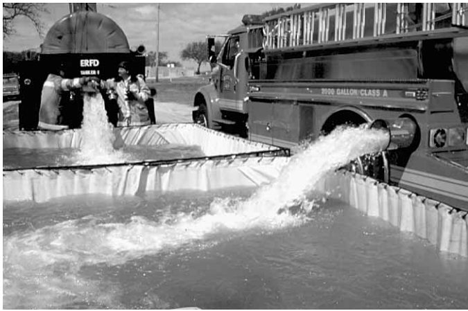
Figura 2.10 La utilización de depósitos portátiles de agua es el método más eficaz para proporcionar un abastecimiento continuo de agua mediante camiones cisterna.
