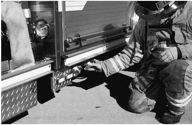
Figura 11.53 Si tapa el orificio de escape de la toma puede mejorar el proceso de cebado.
