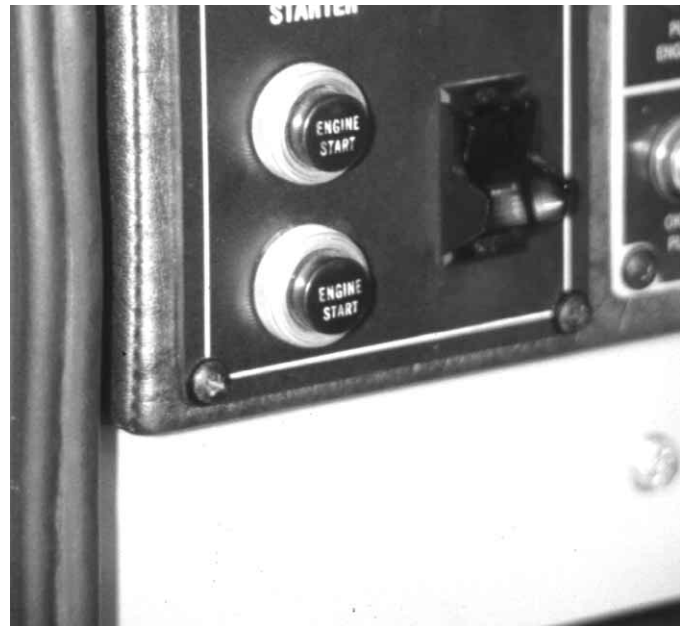
Figura 4.15b Algunos vehículos con diseño especial poseen interruptores de contacto del tipo pulsador.
