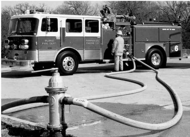
Figura 5.39 Algunos vehículos disponen de una siamesa conectada a la toma grande de la bomba.
