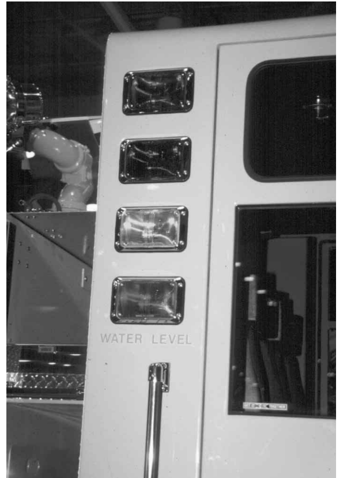
Figura 10.82 Algunos vehículos están equipados con grandes luces indicadoras del nivel del depósito de agua que son visibles desde una distancia considerable del vehículo.
