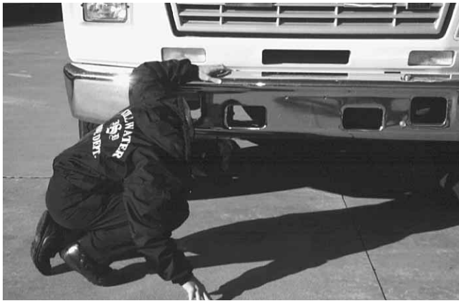
Figura 3.7 Revise los bajos del vehículo para comprobar que no se han producido pérdidas importantes de fluido.
