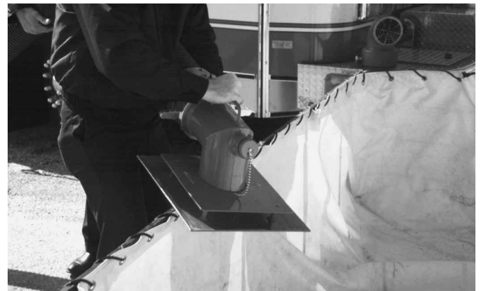
Figura 11.42 Los filtros de nivel bajo suelen utilizarse para succionar desde depósitos portátiles de agua.
