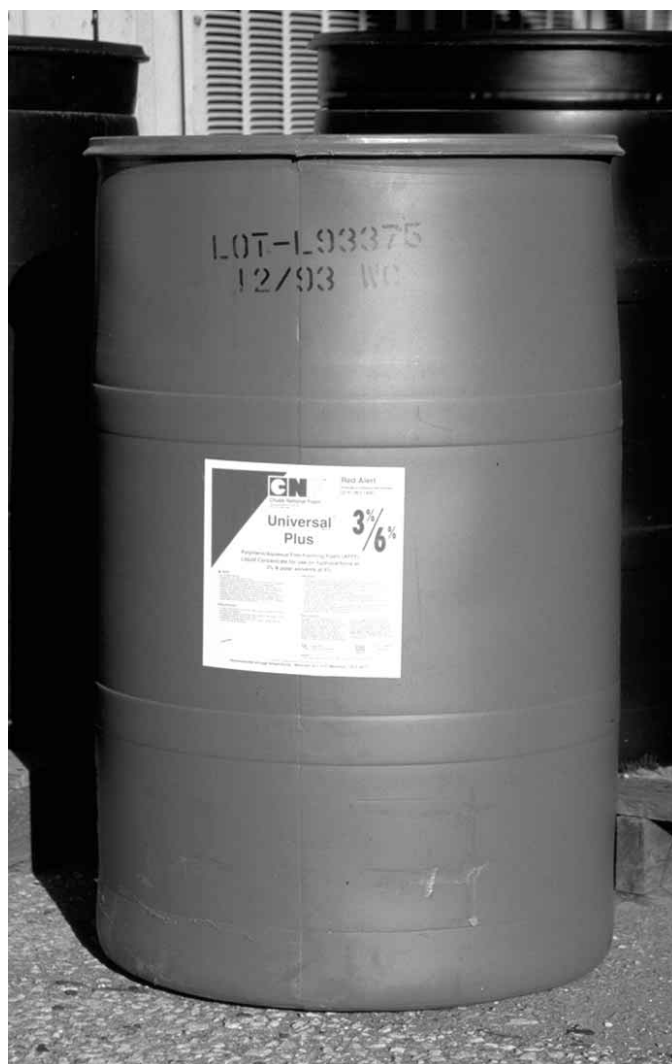
Figura 15.15 La dosificación necesaria debe estar especificada con claridad en el exterior del envase de concentrado de espuma. Gentileza de Conoco Oil Co.
