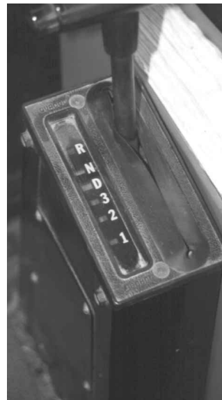
Figura 4.20 Algunas transmisiones automáticas funcionan con una palanca de cambio de marcha.
