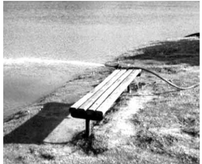
Figura 11.32 Puede engancharse una línea nodriza a algún objeto y enviar un flujo continuo para que la bomba no se recaliente.
