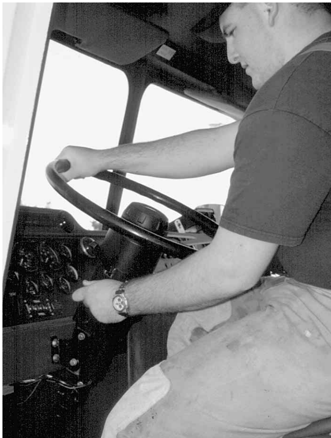
Figura 3.22 Asegúrese de que el volante está ajustado para adaptarse al conductor.
