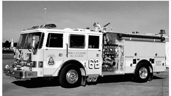
Figura 2.3a Los autobombas de aeropuertos suelen tener dispositivos para espuma. Gentileza de Joel Woods.
