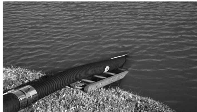
Figura 11.51 Puede utilizarse una escala como base de la manguera de toma durante la succión.
