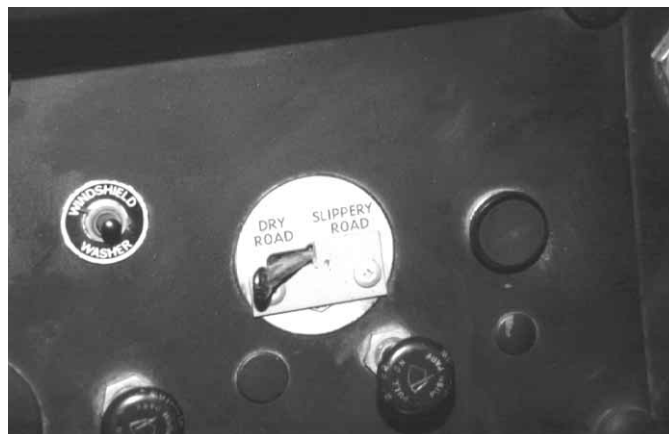
Figura 4.39 Los dispositivos de carretera seca/resbaladiza se utilizaban más en los vehículos antiguos.
