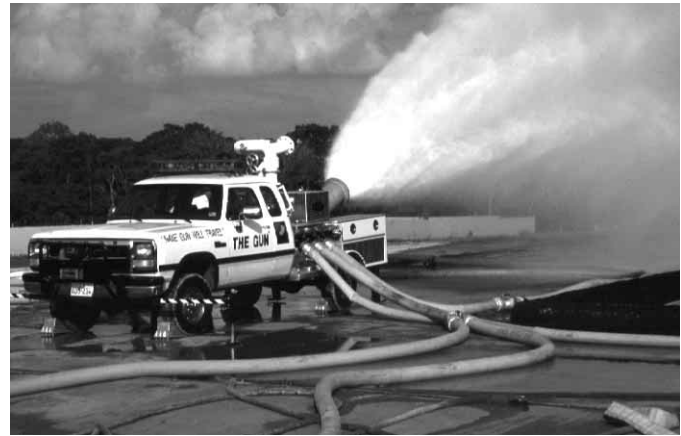
Figura 8.25a Puede que sea necesario abastecer a algunos dispositivos de chorro maestro con grandes cantidades de flujo con líneas de mangueras múltiples de gran diámetro.
