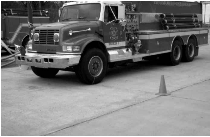
Figura 14.34 Desplace el vehículo hacia delante hasta que la puerta del conductor esté a la misma altura que el cono de tráfico.
