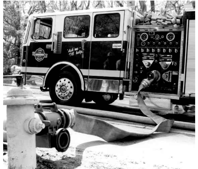
Figura 11.23 El siguiente autobomba que llega al lugar se conecta a la descarga mayor de la válvula del hidrante. Gentileza de Rescate de incendios de Gainesville (Florida, EE.UU.).
