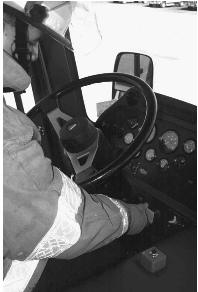
Figura 11.7 Cuando la transmisión esté colocada en la marcha adecuada para una actuación de bombeo en movimiento, puede quitar el freno de mano.
