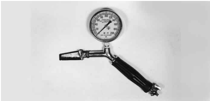
Figura 16.8 Para medir la presión de velocidad de un chorro de agua, se utilizan un tubo de Pitot y un manómetro. La cifra obtenida puede utilizarse para calcular el volumen de flujo.
