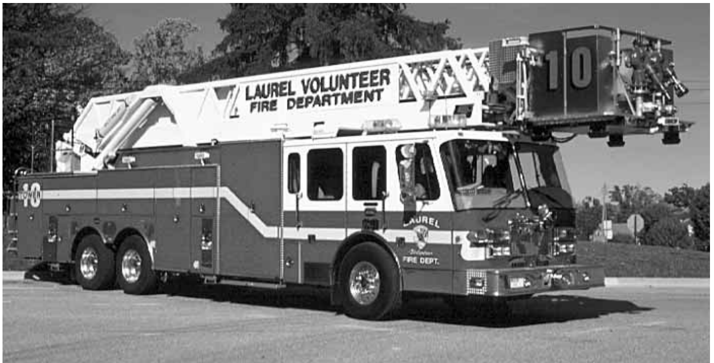
Figura 7.22 Algunas plataformas elevadizas están equipadas con dos dispositivos de chorro maestro. Gentileza de Joel Woods.
