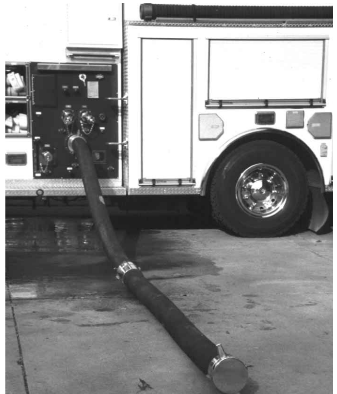
Figura 16.12 Coloque una tapa en el extremo de la manguera de toma que queda suelto.
