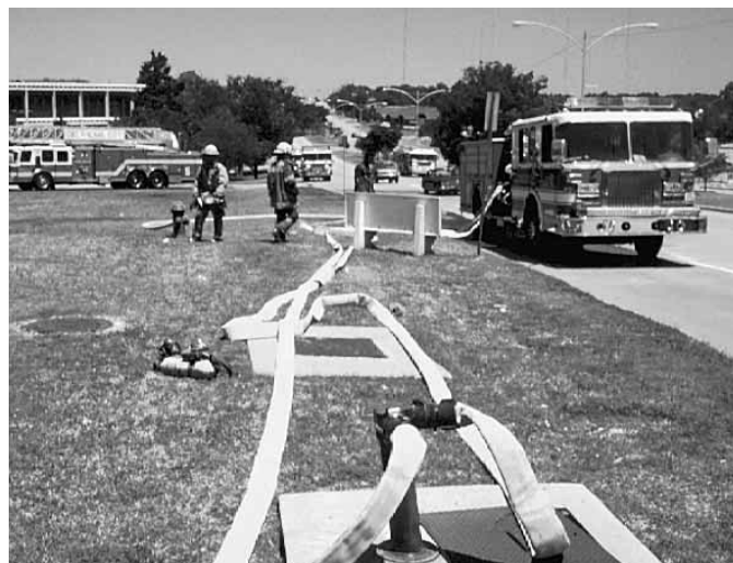
Figura 11.59 El autobomba debe estar conectado a una fuente de abastecimiento y a la conexión del cuerpo de bomberos.
