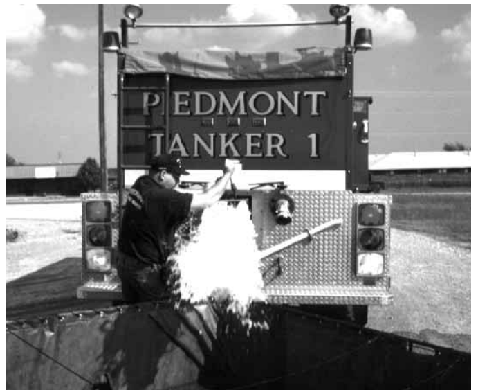
Figura 14.50 El conductor/operario puede abrir la válvula de vaciado con un control directamente en la válvula o con un control remoto situado en la cabina del vehículo, según el diseño del vehículo.
