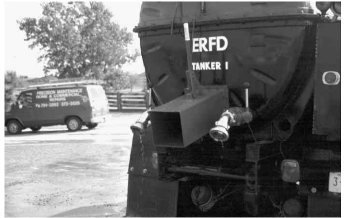
Figura 14.36 Si se utilizan coples Storz, se conectan más rápido las líneas de llenado.
