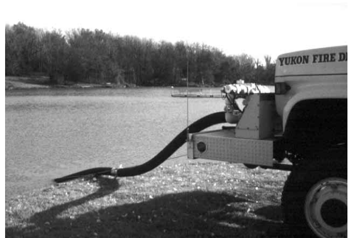
Figura 16.3 Es mejor probar el autobomba utilizando una fuente estática de abastecimiento de agua.
