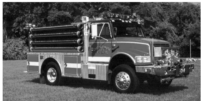
Figura 14.5 Los autobombas de mayor tamaño y con tracción a las cuatro ruedas son excelentes autobombas para el lugar de llenado. Gentileza de Warren Gleitsmann.
