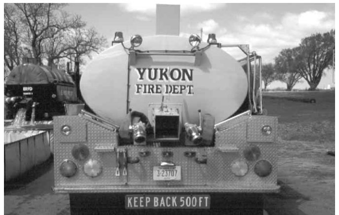
Figura 14.10 Las descargas ubicadas directamente en el depósito son el método más rápido para descargarlo.
