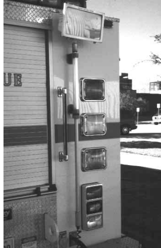
Figura 2.27 Estas lámparas pueden elevarse y girarse manualmente.
