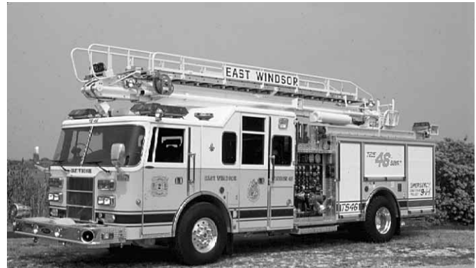
Figura 2.5a Autobomba equipado con un dispositivo telescópico de chorro maestro elevado. Gentileza de Dermot Scales.
