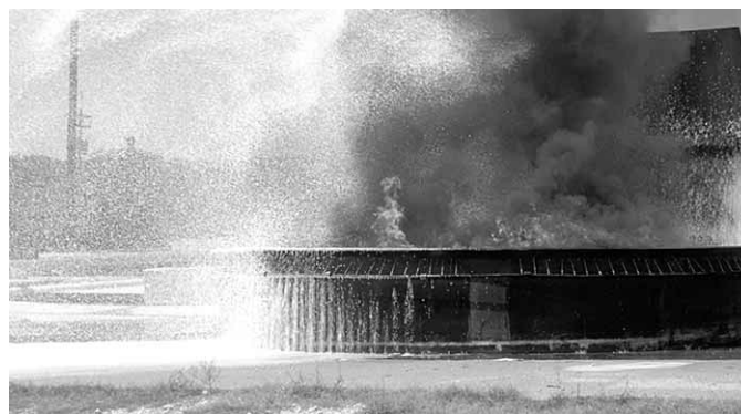
Figura 15.47 Aplicación de espuma mediante el método de lluvia.
