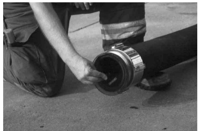
Figura 16.16 Apoye la junta y la lámina de plástico contra el extremo de la manguera de toma. Observe que esta foto sólo muestra el modo en que se haría. Si se realizara una prueba real, la manguera estaría elevada.
