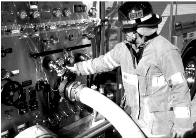
Figura 10.25 En algunos casos, el operario puede detectar el calor de la bomba tocando las tuberías de entrada.
