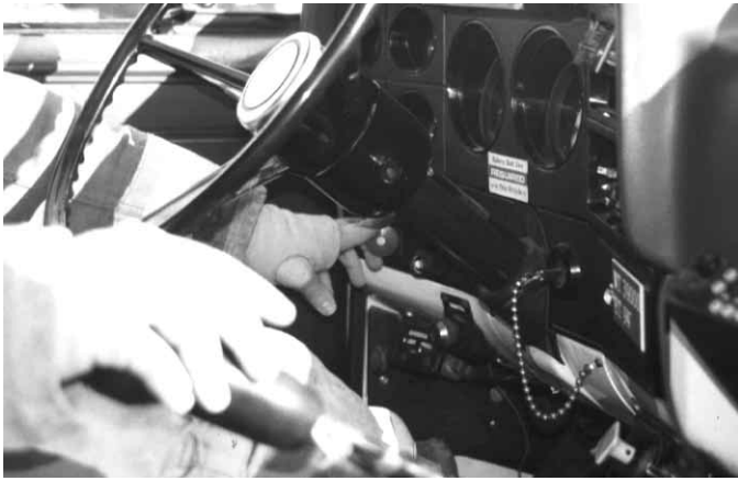
Figura 11.5 El conductor/operario activa la toma de fuerza mientras la transmisión está en punto muerto.
