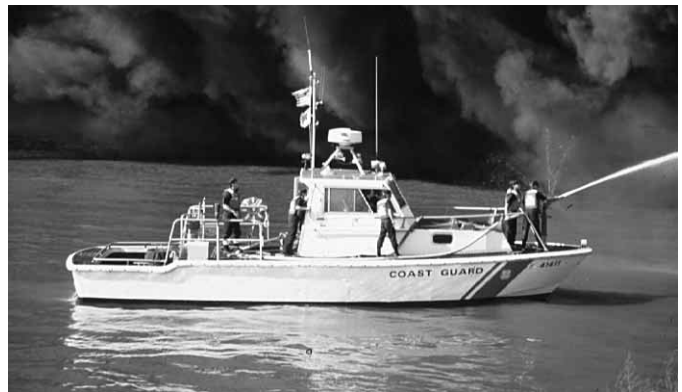
Figura 2.19b Los barcos-bomba pequeños pueden maniobrar en aguas que no son lo suficientemente profundas para barcos de mayor tamaño. Gentileza de Ron Jeffers.
