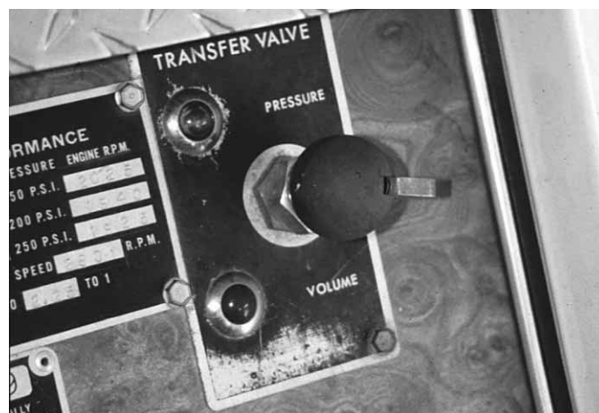
Figura 3.44 Si el vehículo dispone de una bomba de dos posiciones, ponga en marcha la válvula de conmutación para cerciorarse de que funciona correctamente.
