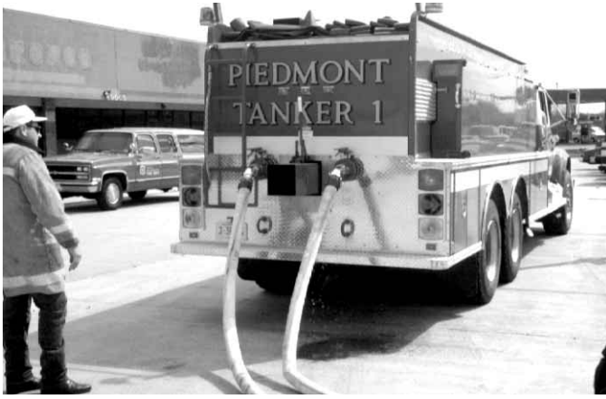
Figura 14.11 Se utilizan dos líneas de mangueras de diámetro mediano para llenar el camión cisterna.
