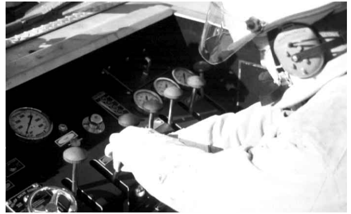
Figura 11.12 La válvula que conecta la bomba con el depósito se activa cuando el conductor/operario llega hasta el panel de la bomba.
