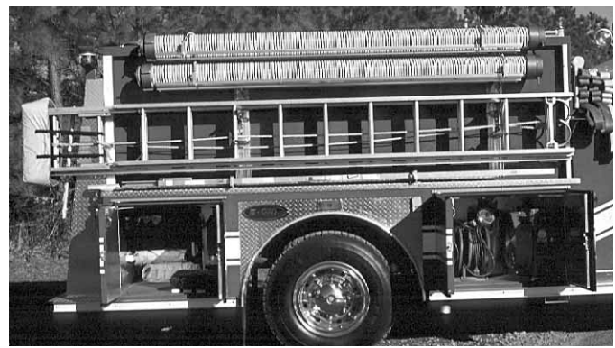
Figura 3.14 En esta fase de la inspección se deben revisar ambos laterales del vehículo, desde la parte trasera de la cabina hasta la parte posterior del vehículo. Gentileza de Joel Woods.
