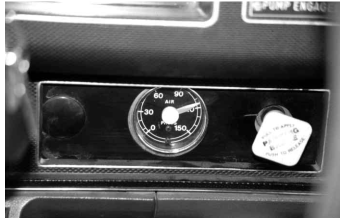
Figura 4.17 La mayoría de vehículos modernos están equipados con indicadores de presión del aire y del aceite en el salpicadero.
