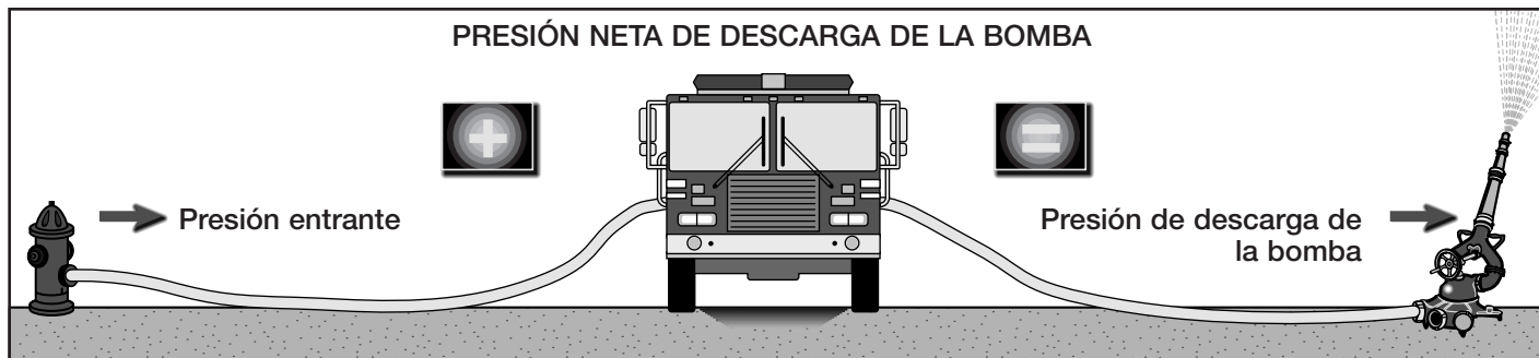
Figura 10.14 La presión neta de descarga de la bomba es la suma de la presión entrante en la bomba más la presión creada por la bomba.
