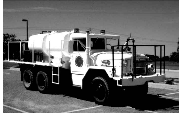
Figura 4.4 Los vehículos con centros de gravedad elevados son especialmente propensos a volcar.
