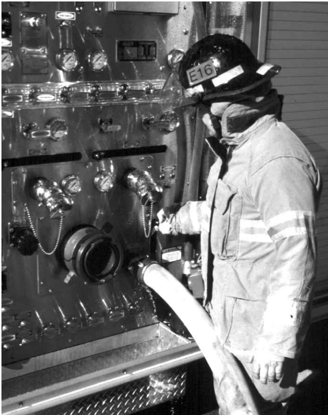
Figura 11.17 Después de purgar el aire de la línea, puede abrirse la válvula de toma conmutada.
