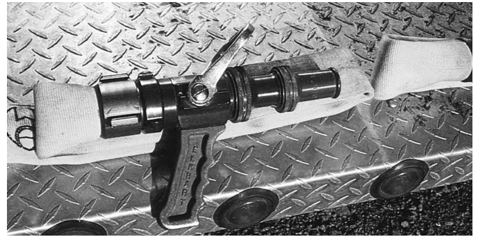
Figura 15.34a Boquilla típica de chorro directo que puede utilizarse con un chorro producido por un sistema de espuma de aire comprimido. Gentileza del Distrito de protección contraincendios de Mount Shasta, California (EE.UU.).
