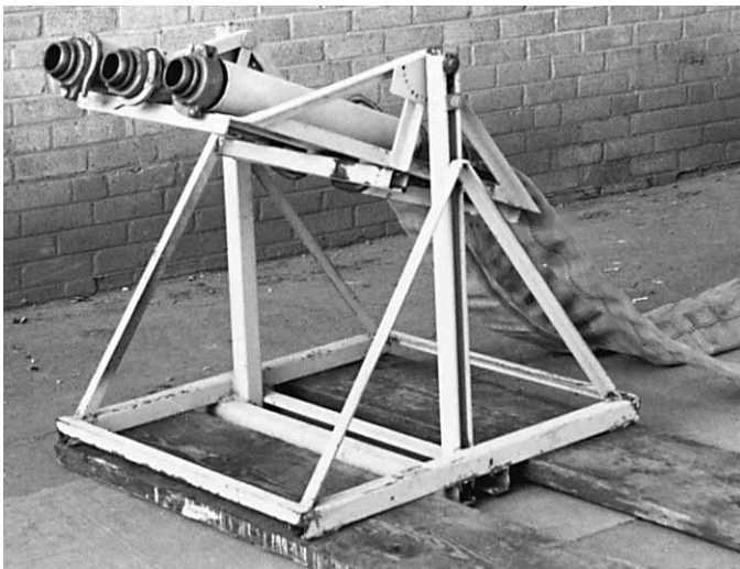
Figura 16.9a Este soporte para boquillas de prueba permanece en su lugar gracias a que se aparca un vehículo sobre las dos tablas situadas en la base del soporte.
