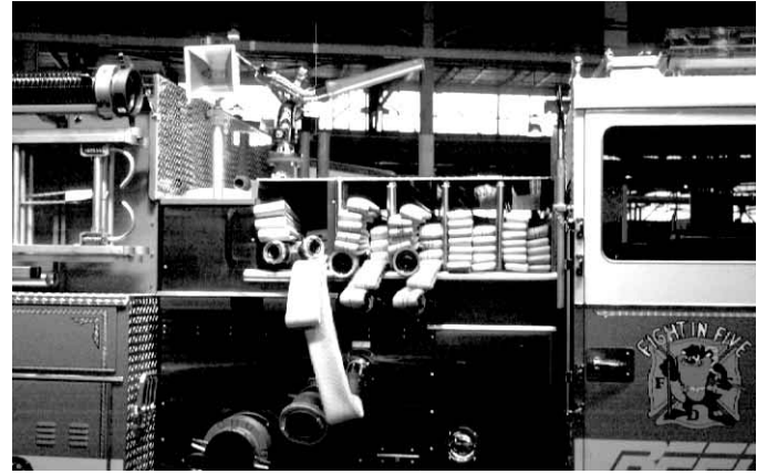
Figura 3.16a Las líneas de mano preconectadas suelen acomodarse en una disposición de tendido cruzado por encima o por debajo del panel de la bomba.
