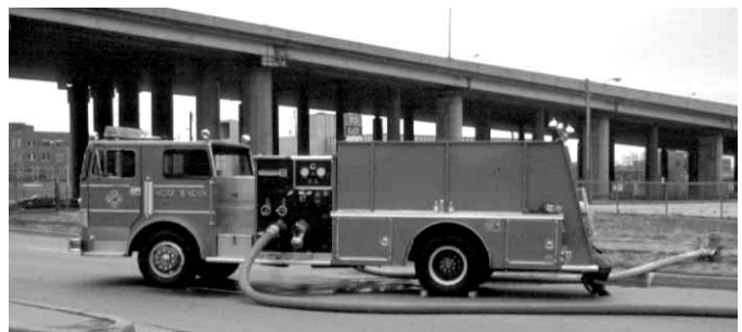
Figura 13.3 Los vehículos para mangueras equipados con una bomba contra incendios pueden participar en el bombeo en serie.
