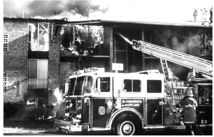
Figura 5.18 En algunos casos, puede utilizarse la bomba del vehículo para abastecer al chorro elevado. Gentileza de Joel Woods.
