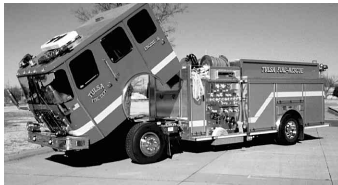
Figura 3.29 Si se inclina la cabina, se tiene acceso al motor y al sistema de transmisión del vehículo.
