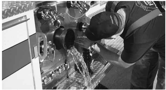
Figura 3.43 Retire la tapa de la toma para comprobar que el filtro no esté obstruido.
