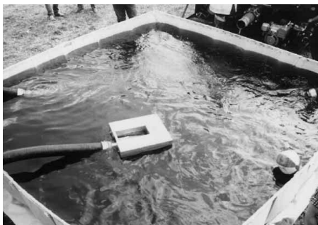
Figura 5.27 Los filtros flotantes mantienen la manguera de toma cerca de la superficie del agua.
