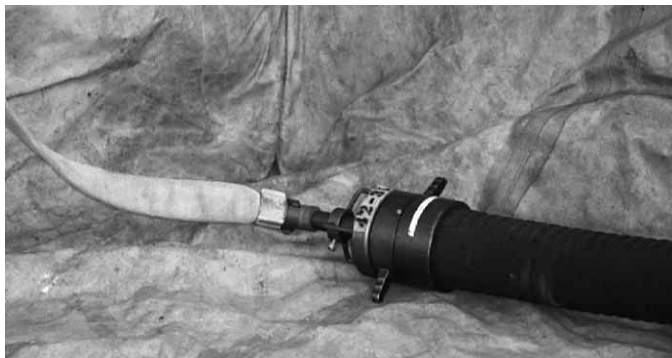
Figura 14.53 El dispositivo de sifón a chorro se abastece de una línea de mangueras pequeña.
