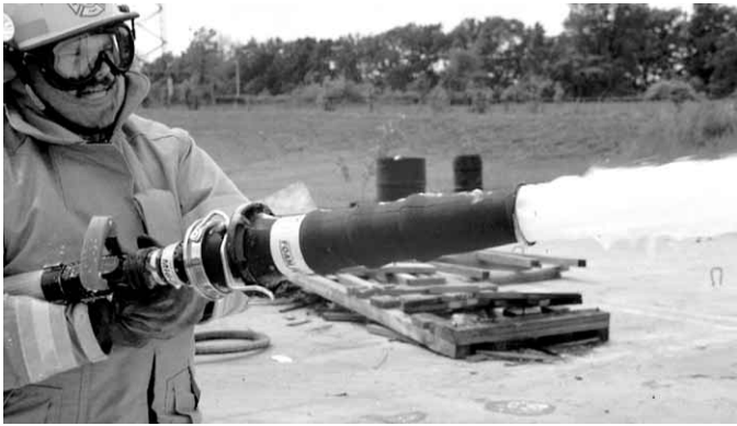
Figura 15.36 Puede unirse este accesorio a la boquilla nebulizadora para aumentar la aireación de la espuma. Gentileza de KK Products.
