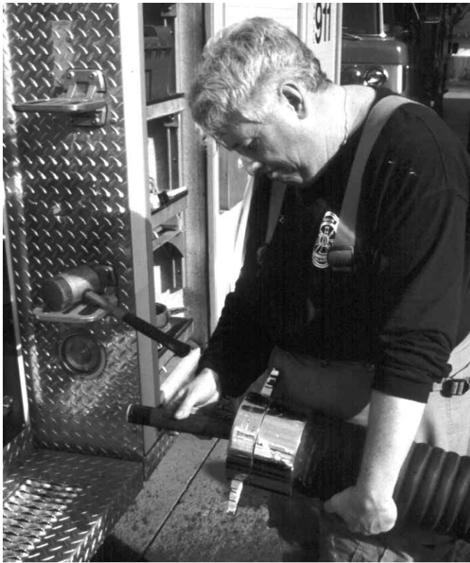
Figura 16.14 Introduzca la linterna encendida en la manguera antes de conectarla al panel de la bomba.
