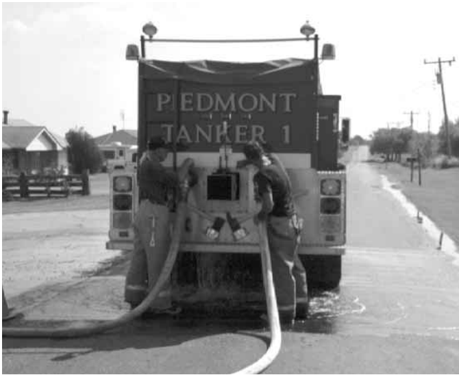
Figura 14.38 El personal de conexión y desconexión debe permanecer siempre junto a las líneas de mangueras.
