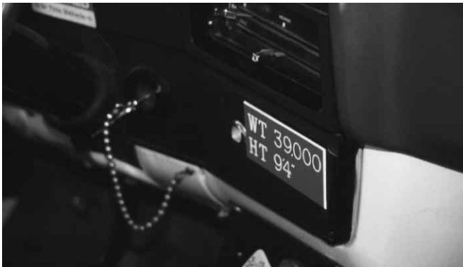
Figura 11.6 El indicador se enciende si la toma de fuerza está en marcha.
